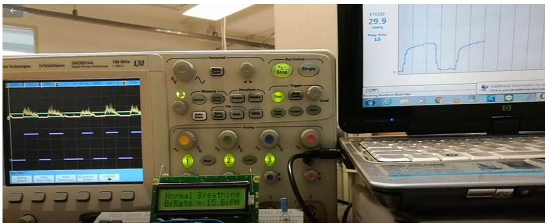
รูปที่ 5.44 การทดสอบ BrRate Monitor เทียบกับ Capnography Meter (หายใจแผ่วที่ความถี่ปกติ)
