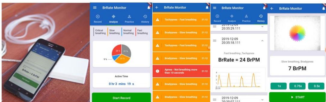
รูปแสดงตัวเครื่อง(สีขาว) ท่อนำเสียง และหน้าจอแสดงผลแบบต่าง ๆ 5 แบบของแอปพลิเคชันบน
