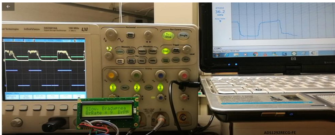
รูปที่ 5.45 การทดสอบ BrRate Monitor เทียบกับ Capnography Meter (หายใจแรงปกติที่ความถี่ช้ากว่าปกติ)
