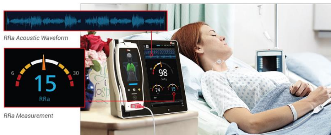
รูปที่ 5.1 อัตราการหายใจโดยใช้เซนเซอร์เสียงวางชิดติดกับผิวหนังบริเวณลำคอ
