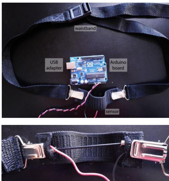
รูปที่ 2.16 ตัวอย่างการวัดอัตราการหายใจโดยการวัดค่าความต้านทานของสเตรนเกจที่ติดอยู่บนสายรัดทรงอกหรือรอบเอว
