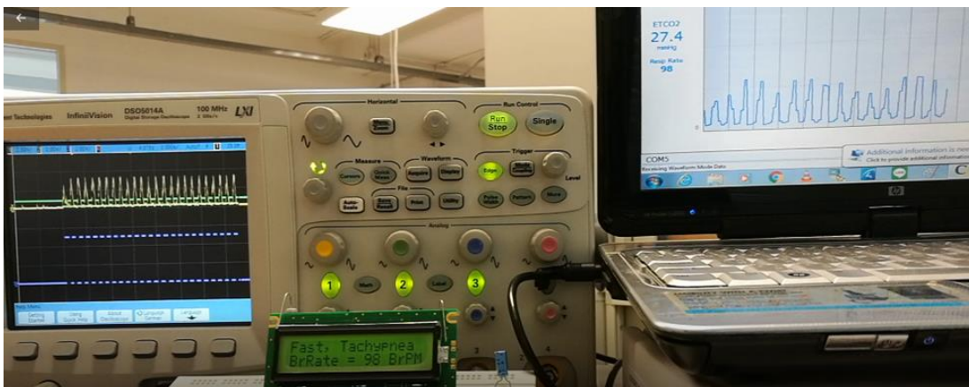
รูปที่ 5.47 การทดสอบ BrRate Monitor เทียบกับ Capnography Meter (หายใจแรงปกติที่ความถี่สูง)
