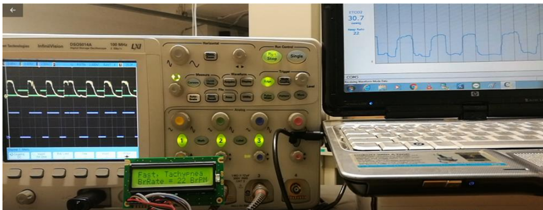
รูปที่ 5.46 การทดสอบ BrRate Monitor เทียบกับ Capnography Meter (หายใจแรงปกติที่ความถี่เร็วกว่าปกติ)
