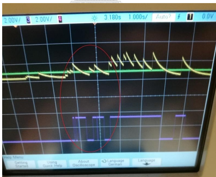
รูปที่ 6.10 สัญญาณขาออกจากวงจรเปรียบเทียบสัญญาณทำงานผิดพลาด
