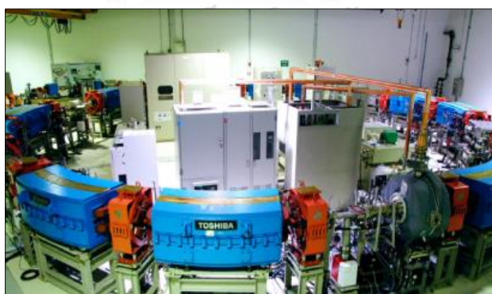
รูปที่ 2.10 เครื่องเร่งอนุภาคแนววงกลม (Booster synchrotron)
