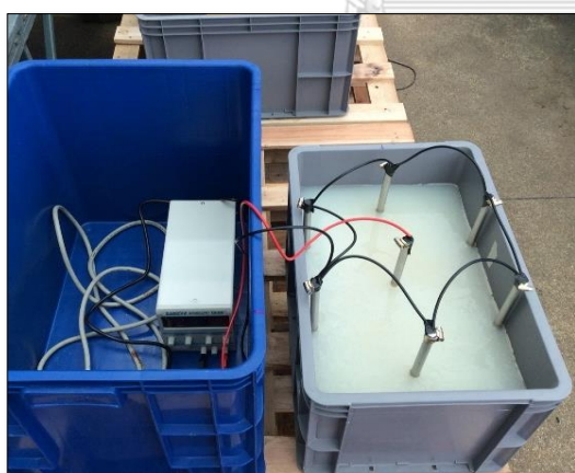
รูปที่ ก4 ก) รูปแบบการวางขั้วในภาชนะทรงเหลี่ยม และ ข) รูปแบบการวางขั้วในภาชนะทรงกลม โดยแบ่งเป็น 2 ส่วน ชั้นที่ไม่มีการปนเปื้อน (สีฟ้า) และชั้นที่มีการปนเปื้อนสารหนู (สีแดง) ค) การเตรียมตัวอย่างวันและการวางขั้วอิเล็กโทรดในภาชนะทรงเหลี่ยม ง) การเตรียมตัวอย่างวันและการวางขั้วอิเล็กโทรดในภาชนะทรงกลม จ) ภาชนะทรงเหลี่ยม และ ฉ) ภาชนะทรงกลม ติดตั้งกับแหล่งป้อนสนามไฟฟ้า (Power supply)
