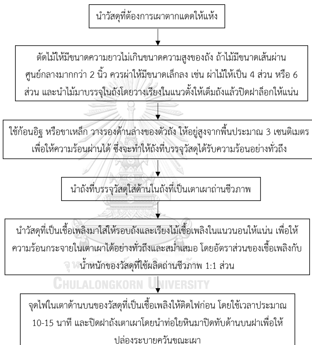
รูปที่ 2.7 แผนผังแสดงขั้นตอนการเผาถ่านชีวภาพ ที่มา: พินิจภณ ปิตุยะ และอนัญญา โพธิ์ประดิษฐ์ (2560)
