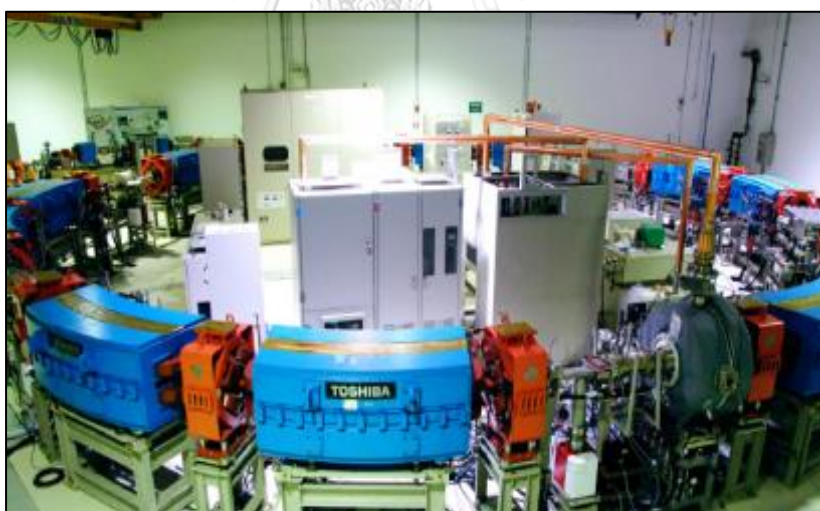
รูปที่ 2.13 เครื่องเร่งอนุภาคแนววงกลม (Booster synchrotron) ที่มา: สถาบันวิจัยแสงซินโครตรอน (2561)
