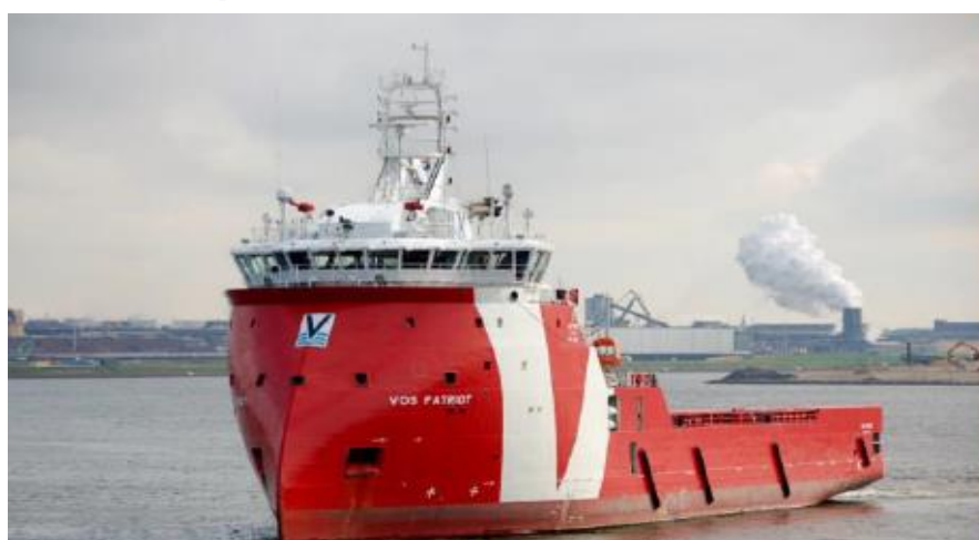
ภาพที่ 1.11 เรือซัพพลาย (Platform Support Vessel , PSV)
