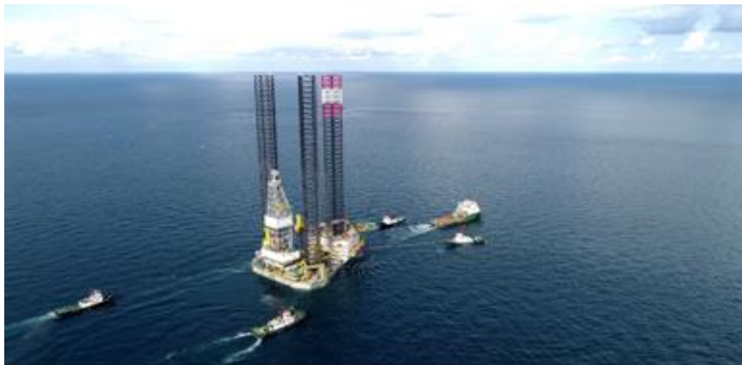
ภาพที่ 1.7 การเคลื่อนย้ายแท่นขุดเจาะชนิดขาห้อย (Jack Up Rig Move Operation)
