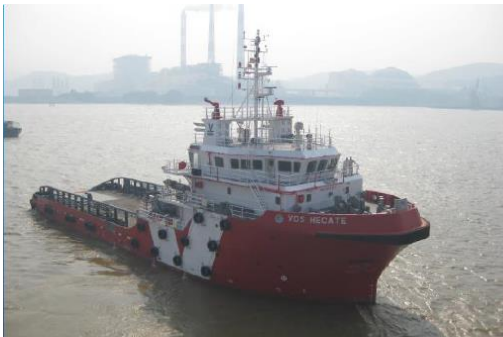
ภาพที่ 1.10 เรือทำสมอและซัพพลาย Anchor Handling and Tug Supply (AHTS)
