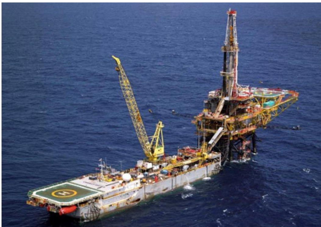
ภาพที่ 1.5 แท่นขุดเจาะชนิดลอยน้ำ (Tender Barge Rig)
