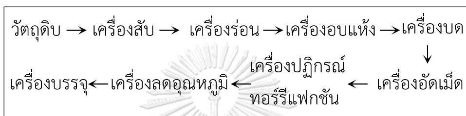
รูปที่ 4-3 ผังกระบวนการผลิตเม็ดเชื้อเพลิงไม้ยางพาราทอร์รีไฟต์แบบอัดเม็ดก่อนการทอร์รีแฟกชัน
