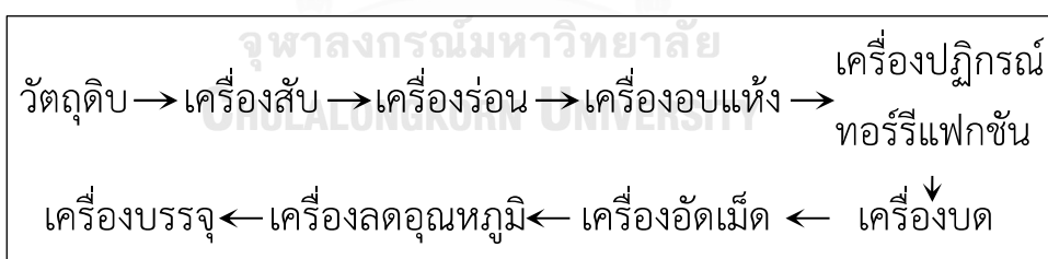
รูปที่ 4-2 ผังกระบวนการผลิตเม็ดเชื้อเพลิงไม้ยางพาราทอร์รีไฟด์แบบอัดเม็ดหลังการทอร์รีแฟกชัน
