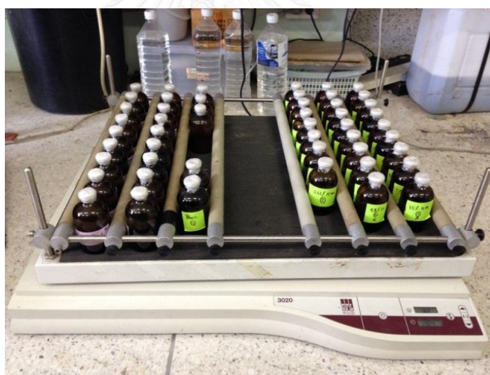
รูปที่ 3 - 7 ชุดการทดลองสำหรับหาปริมาณก๊าซชีวภาพด้วยวิธีบีเอ็มพี
