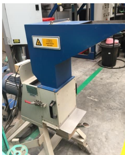
รูปที่ 3.2 เครื่องบดอเนกประสงค์ ขนาด 50 กิโลกรัม
