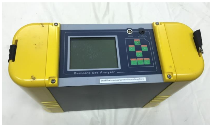
รูปที่ 3.4 เครื่องวิเคราะห์ก๊าซ (Portable infrared Coal gas Analyzer)
