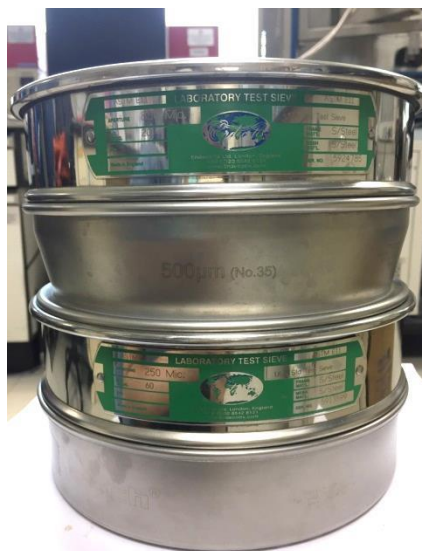
รูปที่ 3.3 ชุดตะแกรงร่อน ขนาด 20 35 และ 60 เมช (mesh)
