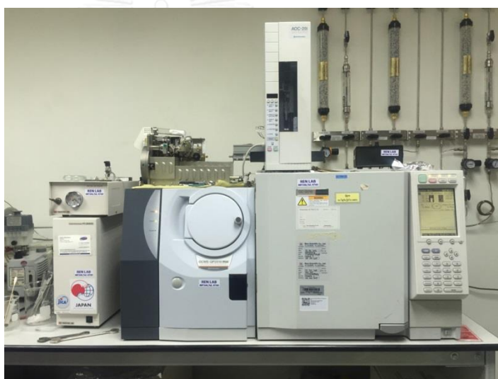
รูปที่ 3.5 เครื่องก๊าซโครมาโทกราฟี-แมสสเปกโตรเมทรี (Gas chromatography-Mass spectrometry)
