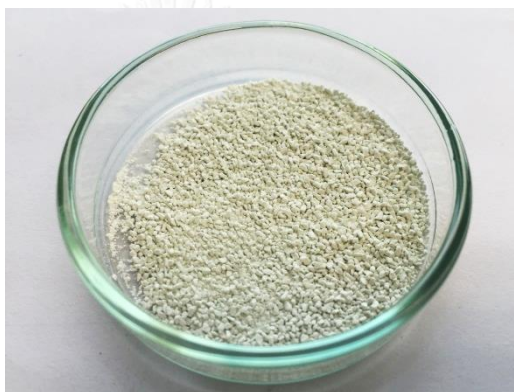
รูปที่ 3.9 ตัวรองรับโดโลไมต์ ขนาด 0.50-0.85 มิลลิเมตร ที่ผ่านการแคลไซน์แล้ว
