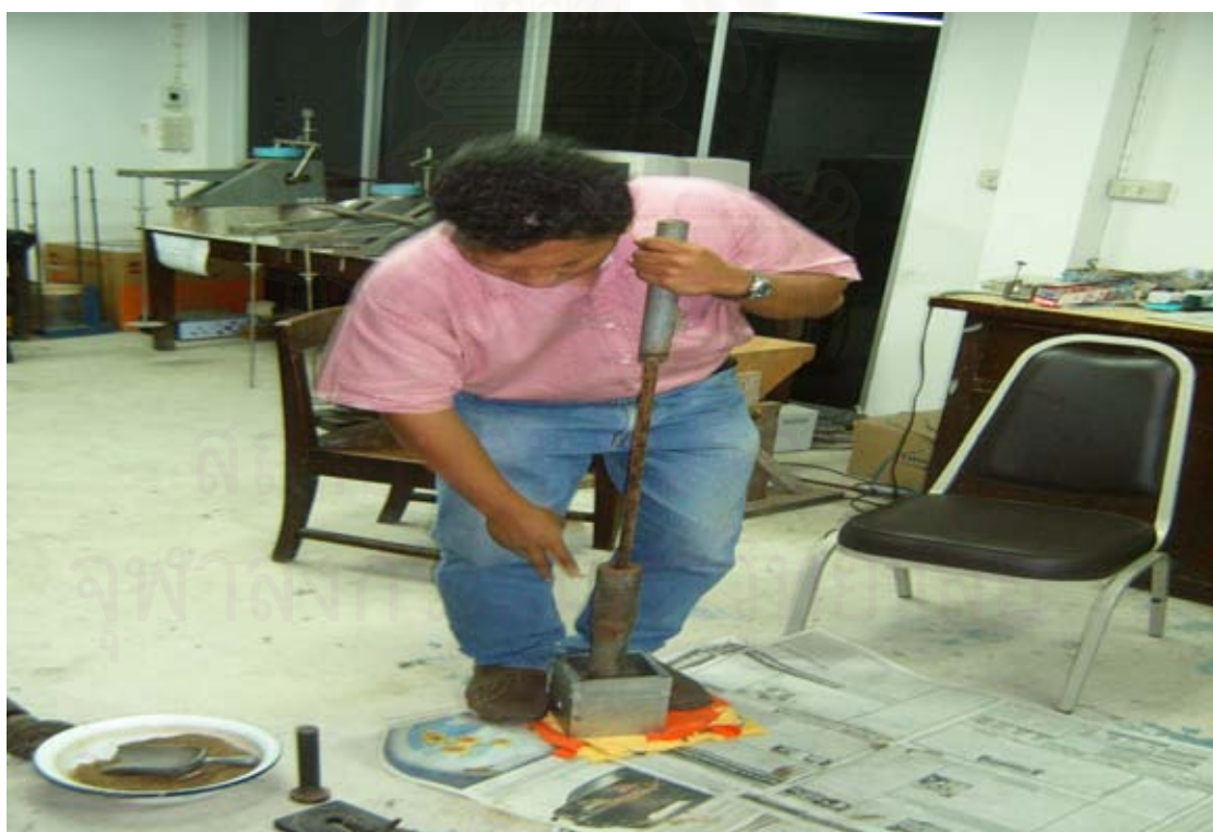
รูปที่ 3.14 การบดอัดตัวอย่างทรายในกล่องตัวอย่าง
