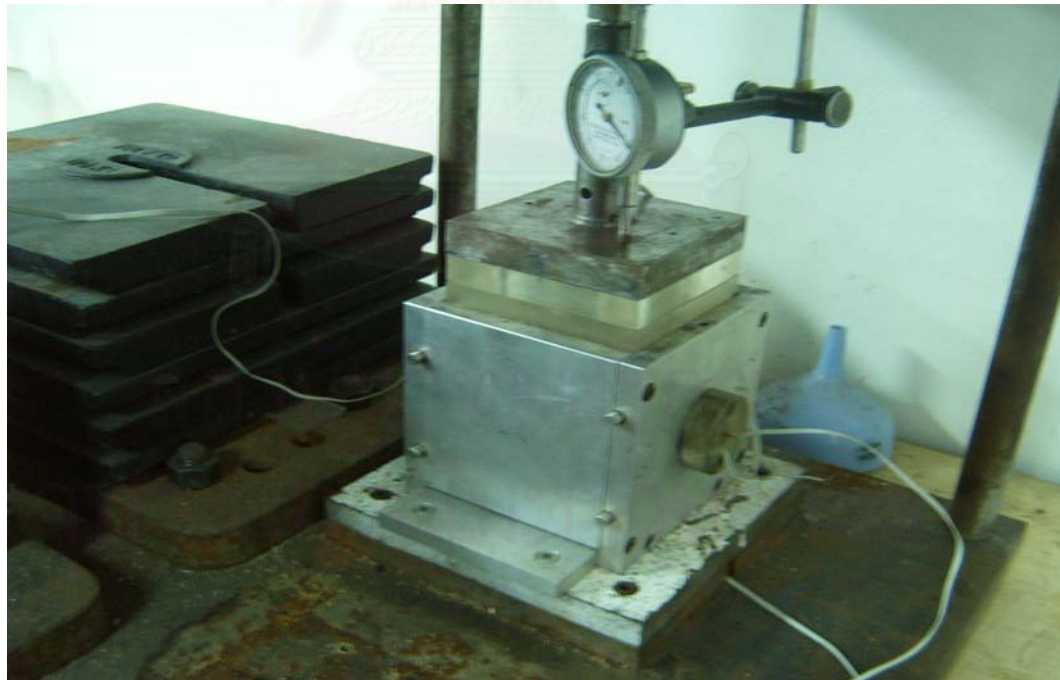
รูปที่ 3.11 ตัวอย่างที่ติดตั้งใน loading frame พร้อมทดสอบ
