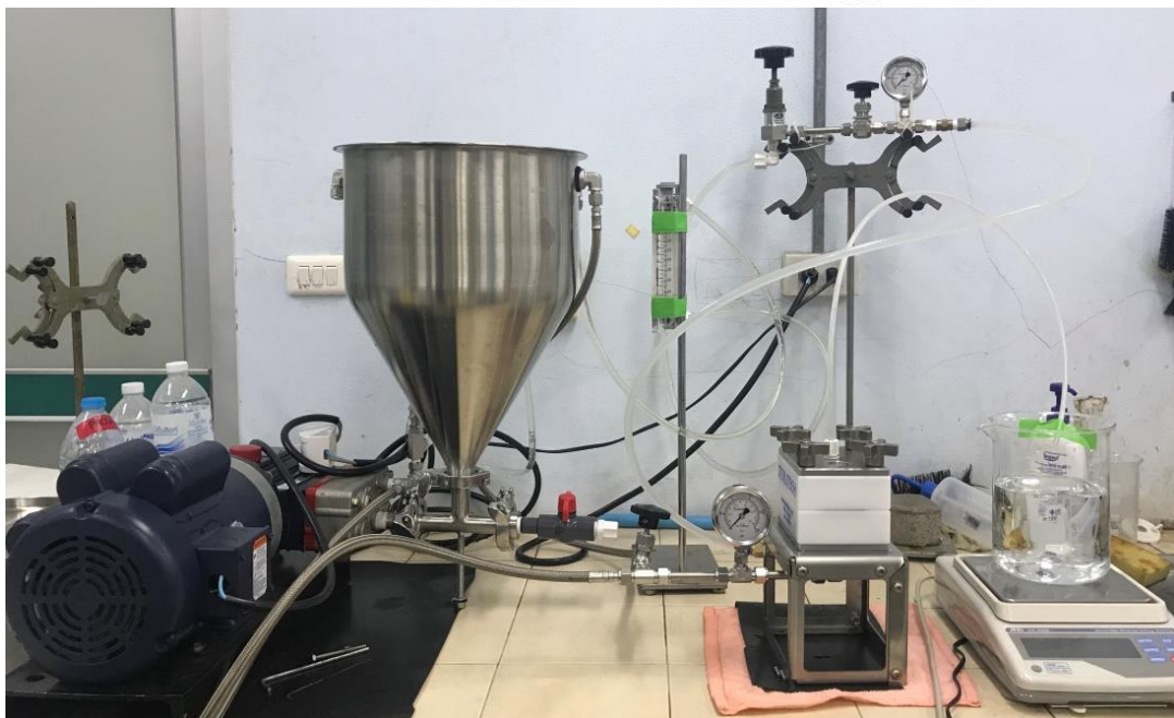
รูปที่ 3.7 แผนผังการติดตั้งอุปกรณ์ของชุดทดสอบที่ใช้ในกระบวนการนาโนฟิลเตรชัน
