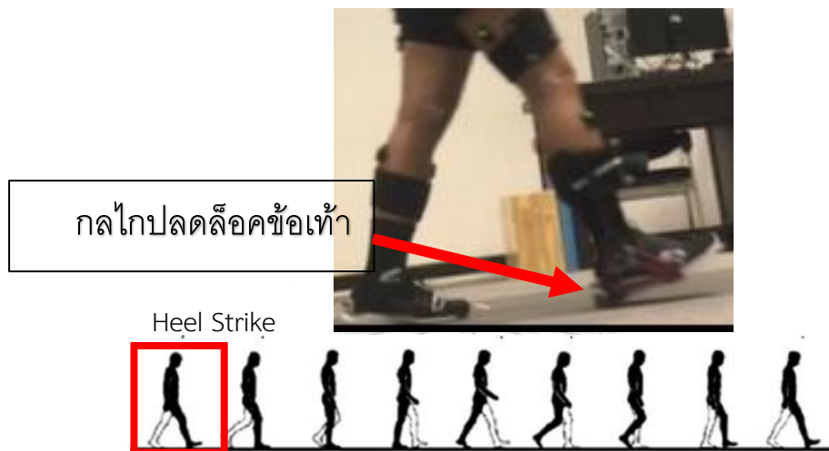
รูปที่ 3.22 อุปกรณ์ช่วยเดินแบบพาสซีฟรุ่นที่ 4 ในช่วง Heel Strike
