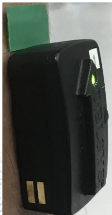
รูปที่ 4.2 อุปกรณ์ตรวจวัดกระแสไฟฟ้าของกล้ามเนื้อไร้สาย ยี่ห้อ Delsys
