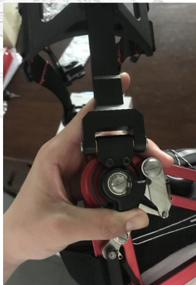
รูปที่ 3.19 ข้อต่อสำหรับการพลิกฝ่าเท้าของอุปกรณ์ช่วยเดินแบบพาสซีฟรุ่นที่ 4
