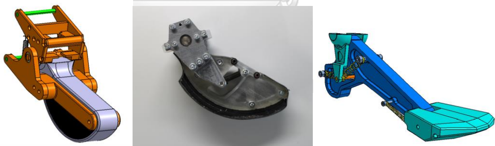
รูปที่ 2.30 รุ่นที่มีเท้าลักษณะคล้ายมนุษย์รุ่นที่1 (1) รุ่นที่มีเท้าลักษณะคล้ายมนุษย์รุ่นที่2 (2) รุ่นที่มีเท้าลักษณะคล้ายมนุษย์รุ่นที่3 (3)[37]
