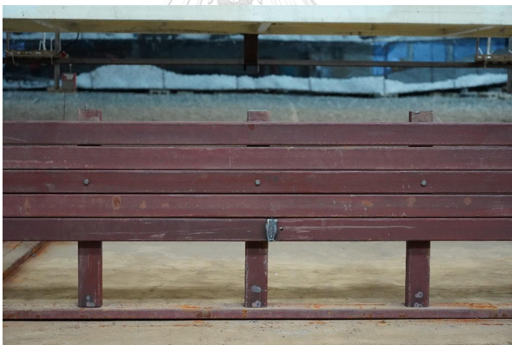
ข) การใช้วัสดุเหล็กกล่องในการจำลองโครงสร้าง
