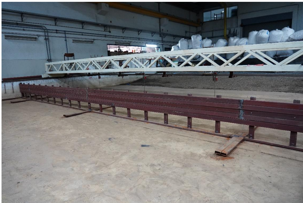
ก) ตัวอย่างแบบจำลองเขื่อนกันคลื่นแบบไม่เต็มส่วน
