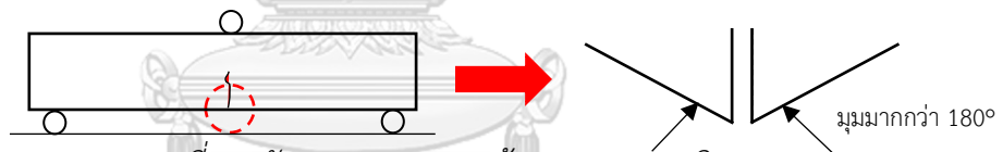
ภาพที่ 42 ลักษณะนูนของรอยร้าวจากการสมมติฐาน
