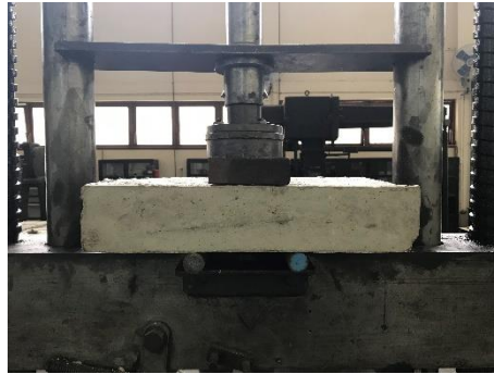
ภาพที่ 22 การทดสอบแรงเฉือนแบบ I
