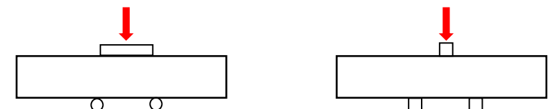
ภาพที่ 21 การทดสอบแรงเฉือนแบบ I และแบบ II
