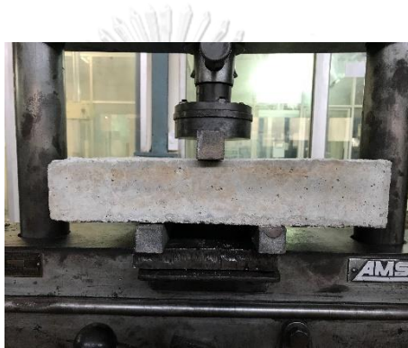
ภาพที่ 23 การทดสอบแรงเฉือนแบบ II
