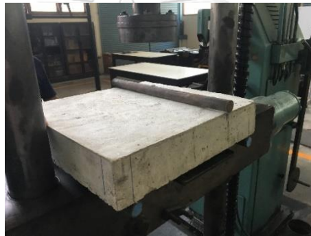
ภาพที่ 20 ตัวอย่างคอนกรีตขณะทดสอบ
