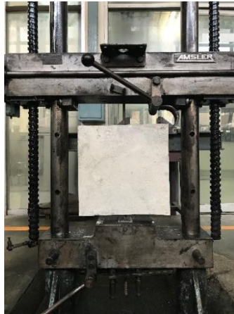
ภาพที่ 25 การทดสอบรับแรงดิ่ง (2)
