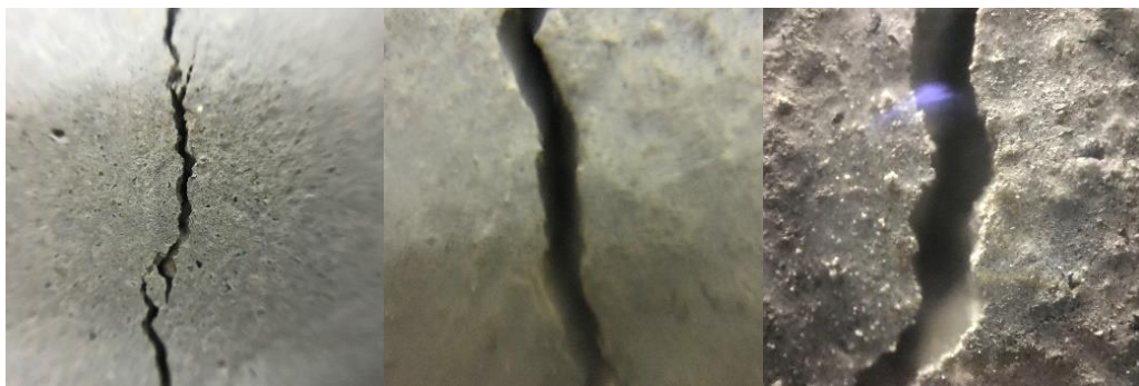
ภาพที่ 51 ภาพถ่ายรอยร้าวจากเลนส์ 20, 40 และ 50 เท่า จากการทดสอบแรงเฉือน (1)
