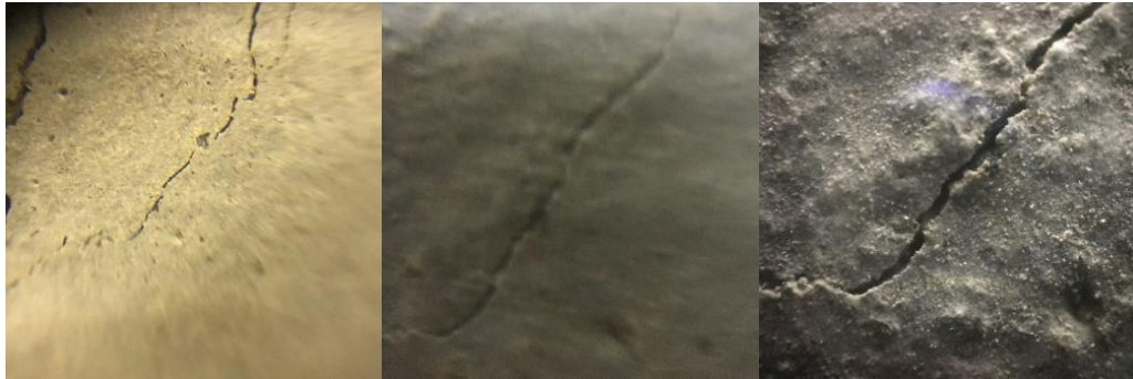
ภาพที่ 52 ภาพถ่ายรอยร้าวจากเลนส์ 20, 40 และ 50 เท่า จากการทดสอบแรงเฉือน (2)
