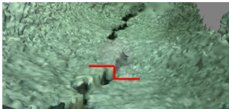
ภาพที่ 67 แบบจำลองรอยร้าวจากการทดสอบแรงเฉือน (1)
