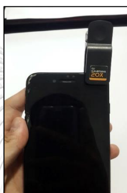
ภาพที่ 30 การติด Chula Smart Lens กับ Iphone7
