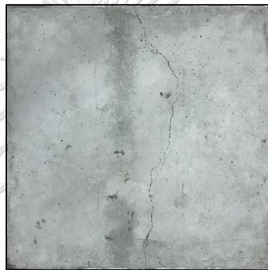
ภาพที่ 47 รอยร้าวจากการทดสอบแรงเฉือน
