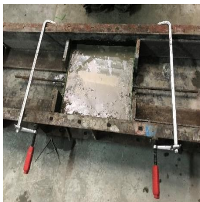
ภาพที่ 17 ตัวอย่างคอนกรีตรับแรงดึง
