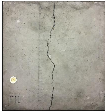
ภาพที่ 46 รอยร้าวจากการทดสอบแรงดัด
