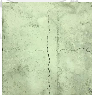
ภาพที่ 48 รอยร้าวจากการทดสอบแรงดึง
