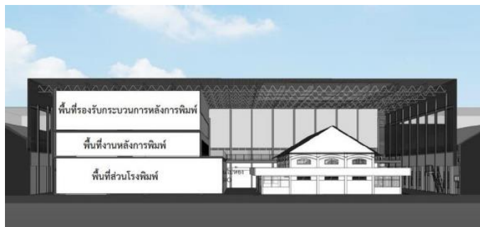
รูปที่ 3.19 แสดงรูปตัดของโรงงานไฟ และแนวความคิด one roof concept (ที่มา: โรงงานไฟ กรมสรรพสามิต)
