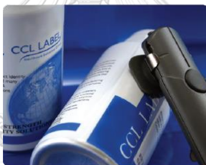
รูปที่ 2.5 วัตถุเคมีที่ถูกฝังในเนื้อกระดาษ สามารถมองเห็นได้ผ่านอุปกรณ์ตรวจจับ
