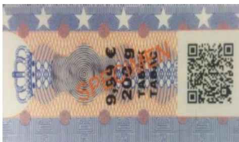
รูปที่ 3.24 แสดงการพิมพ์อิงค์เจต (Inkjet and Numbering)
