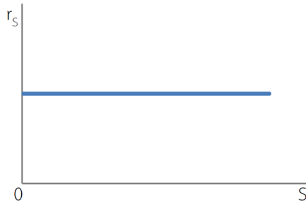
รูปที่ 2-11 จลนพลศาสตร์อันดับศูนย์ (Zero order kinetics)
