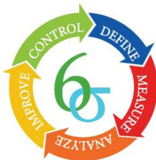
รูปที่ 2.2 วงจรการทำงานตามกระบวนการของ DMAIC (แหล่งที่มา: https://www.sixsigmadaily.com/what-is-dmaic/ )
