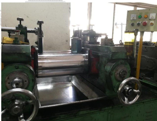
รูปที่ 5.2 เครื่องผสมแบบเปิดสองลูกกลิ้ง (Two-roll mill) ที่ใช้จำลองกระบวนการผสมยาง EPDM non-oil มาสเตอร์แบทในขั้นตอนที่ 2 (Lab scale) (แหล่งที่มา: นภนิกันต์ วงศ์ทรัพย์สกุล, 2562)
