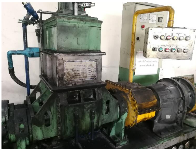
รูปที่ 5.1 เครื่องผสมแบบปิดชนิดเตอร์ (Kneader) ขนาด 5 ลิตรที่ใช้จำลองกระบวนการผสมยาง EPDM non-oil มาสเตอร์แบทในขั้นตอนที่ 1 (Lab scale) (แหล่งที่มา: นภนิกันต์ วงศ์ทรัพย์สกุล, 2562)
