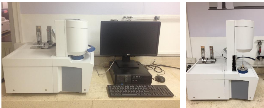
รูปที่ 3.2 เครื่องวัดการเปลี่ยนแปลงขนาดของวัสดุเมื่อได้รับความร้อน Thermomechanical Analysis (TMA)
