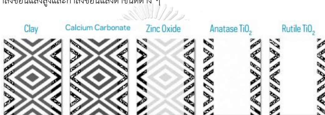
รูปที่ 2.4 การปิดบังพื้นผิวของสีน้ำทาอาคารที่ใช้ผงสีแบบให้กำลังซ่อนแสงสูงและกำลังซ่อนแสงต่ำชนิดต่าง ๆ
