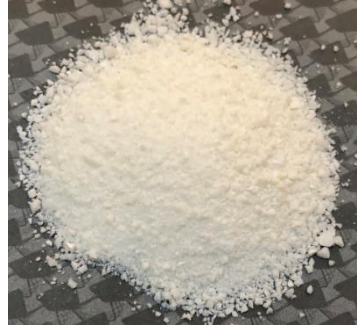
รูปที่ 4.20 ลักษณะของวัสดุมาตรฐานหลังจากการบดภายใต้ ไนโตรเจนเหลว
