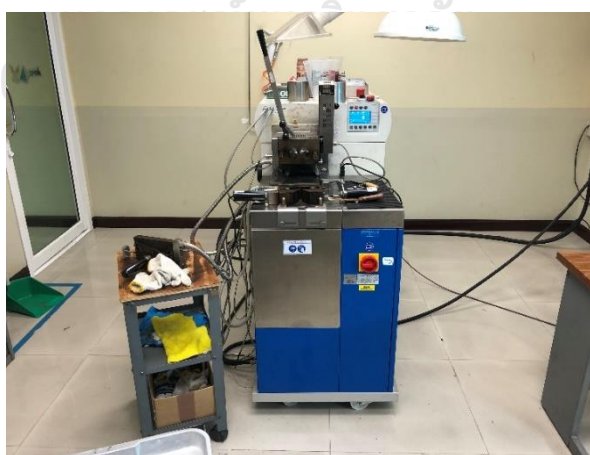
รูปที่ 3.12 เครื่องผสมพอลิเมอร์แบบไม่ต่อเนื่อง
