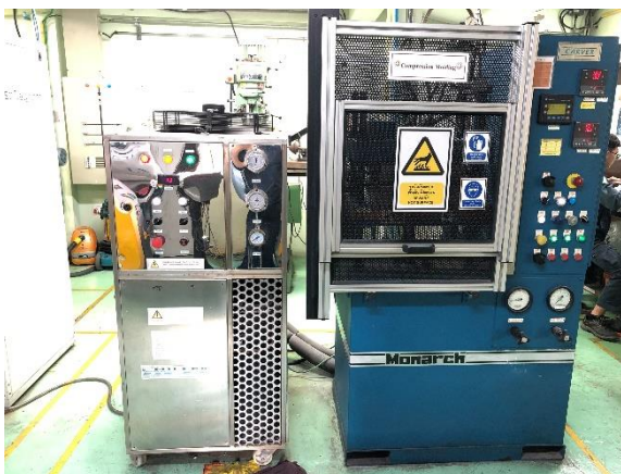
รูปที่ 3.16 เครื่องอัดขึ้นรูปชิ้นงาน (CMG30-12-ASTM-X, Carver, USA)
