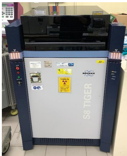
รูปที่ 3.17 เครื่องเอกซเรย์ฟลูออเรสเซนซ์แบบแจกแจงความยาวคลื่น (S8 Tiger, Bruker, Germany)
