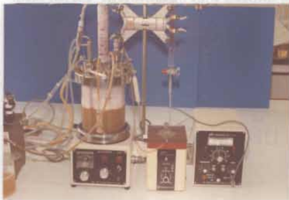
รูปที่ 15 แสดงภาพกระบวนการหมักแบบไม่ต่อเนื่องของ starch hydrolysate ที่ pH ต่าง ๆ
