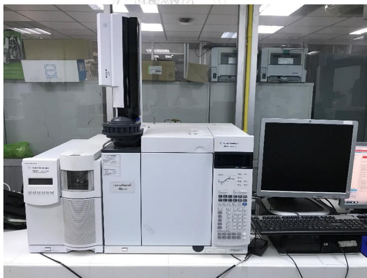
รูปที่ 3.8 เครื่องแก๊สโครมาโทกราฟีร่วมกับแมสสเปคโตรมิเตอร์
