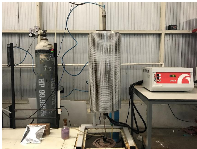
รูปที่ 3. 2 ระบบของกระบวนการสำหรับเครื่องปฏิกรณ์แบบเบดนิ่งที่ใช้ในงานวิจัย
