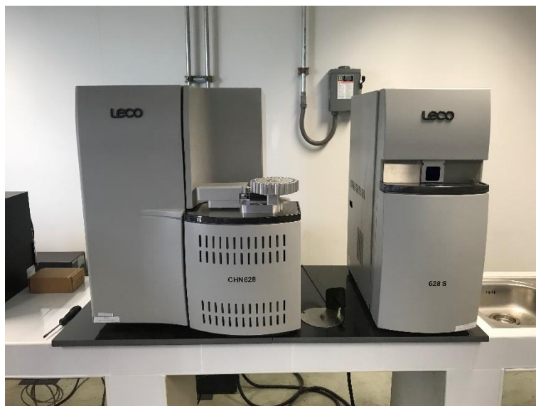
รูปที่ 3.5 เครื่องวิเคราะห์ธาตุ (CHN and S analyzer)
