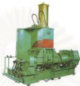
รูปที่ 2.6 เครื่องผสมภายในแบบบานบุรี (Banbury Internal mixer) [6]
