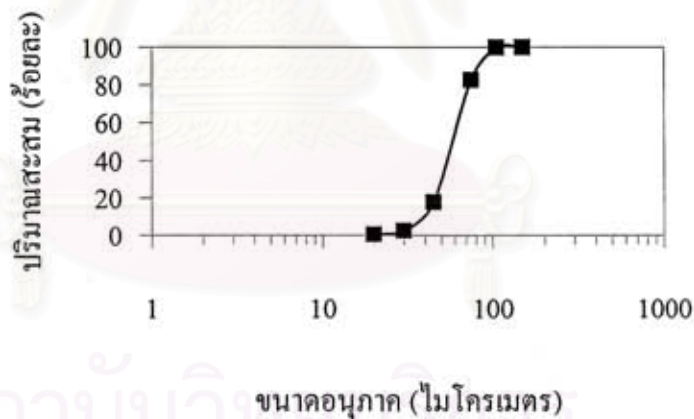
รูปที่ 4.6 กราฟแสดงการกระจายขนาดอนุภาคแบบสะสมของซีลิกอนคาร์ไบด์ 200
