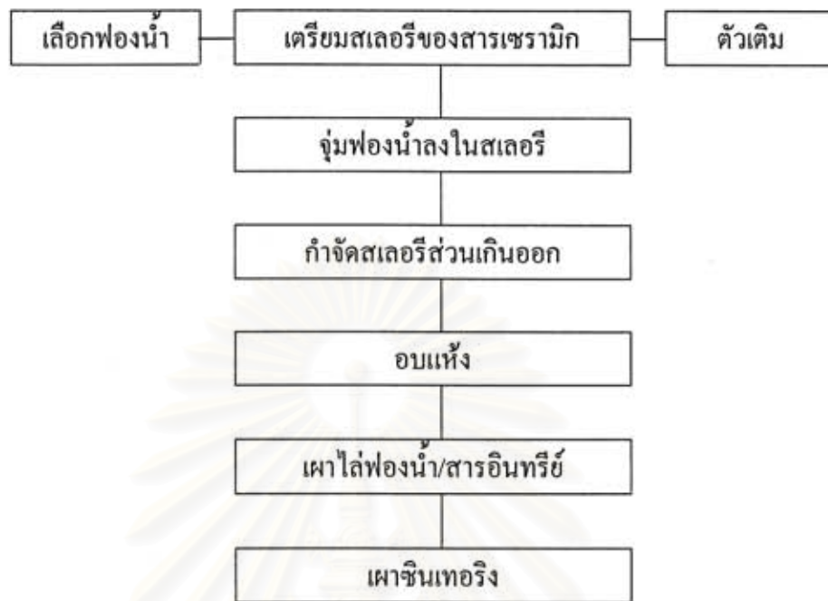
รูปที่ 2.6 รายละเอียดขั้นตอนการขึ้นรูปโดยวิธี Polymeric Sponge
