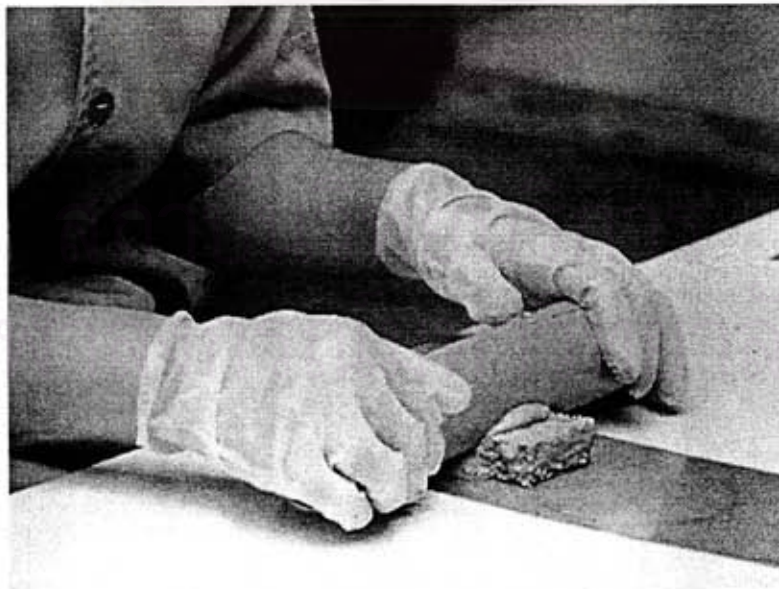
รูปที่ 3.25 การริดสเลอรีส่วนเกินออกจากฟองน้ำ
