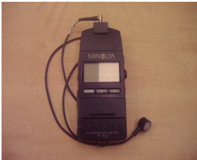
ภาพที่ 3-4 แสดงเครื่องวัดปริมาณการส่องสว่าง Illuminance Meter
