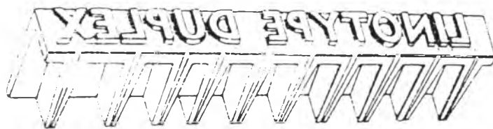
เครื่องไลโนไทป์จะใส่ข้อความติดกันเป็นบรรทัด
