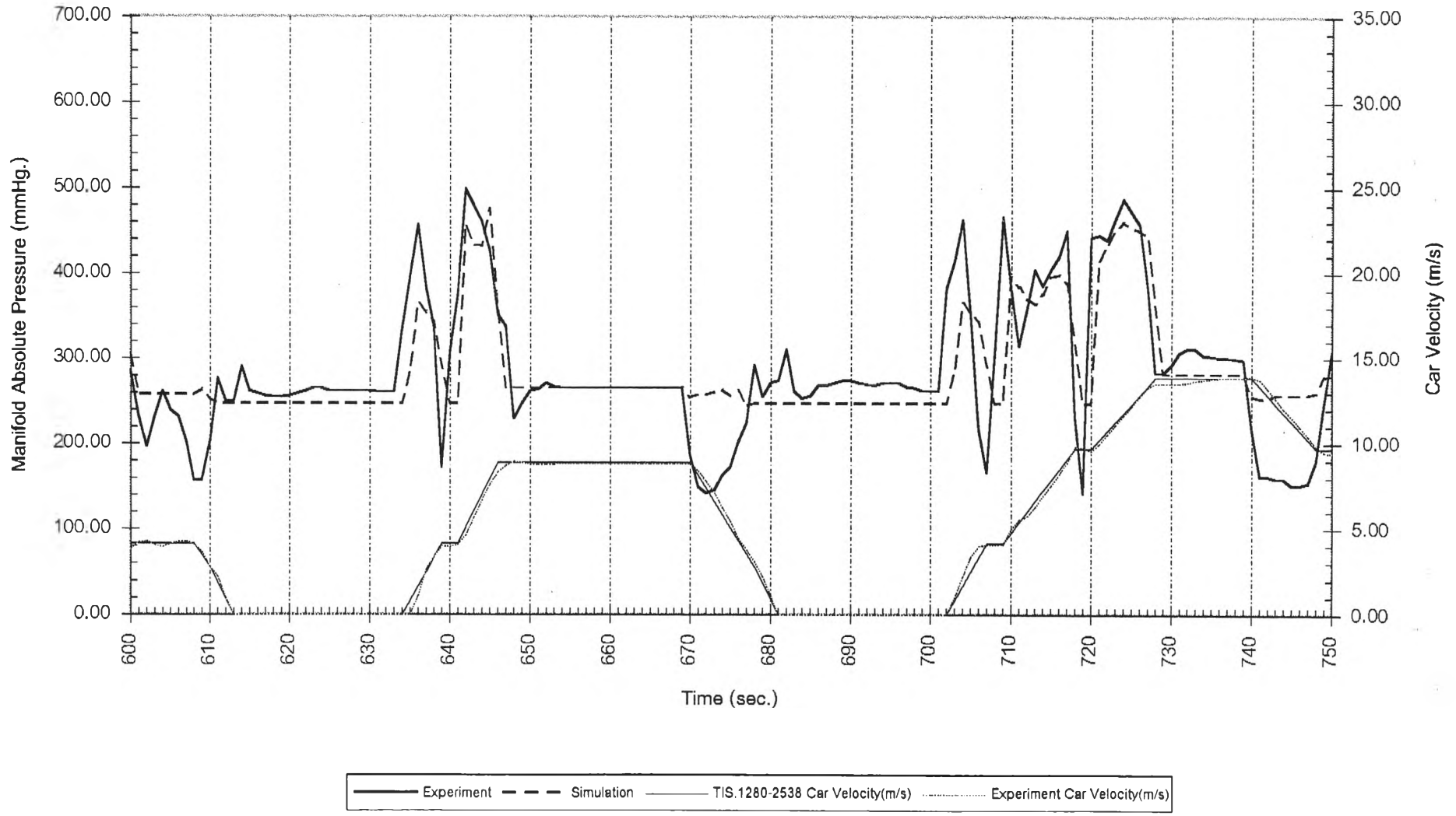
รูปที่ ๗2 (ต่อ) Compare Manifold Pressure from Experiment and Simulation (600-750 s.)
