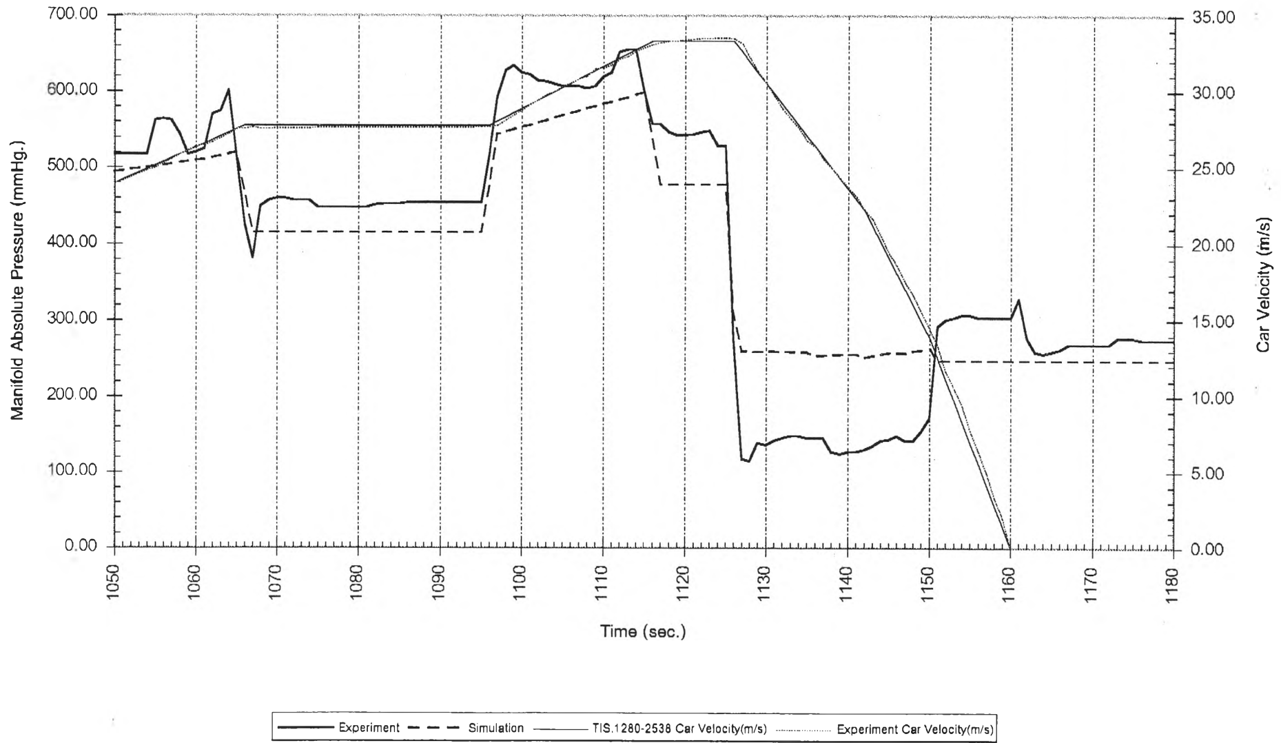
รูปที่ ๗2 (ต่อ) Compare Manifold Pressure from Experiment and Simulation (1050-1180 s.)
