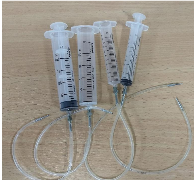
ภาคผนวกรูปที่ 16 หลอดฉีดยาเชื่อมต่อกับท่อซิลิโคนและคอนเนคเตอร์
