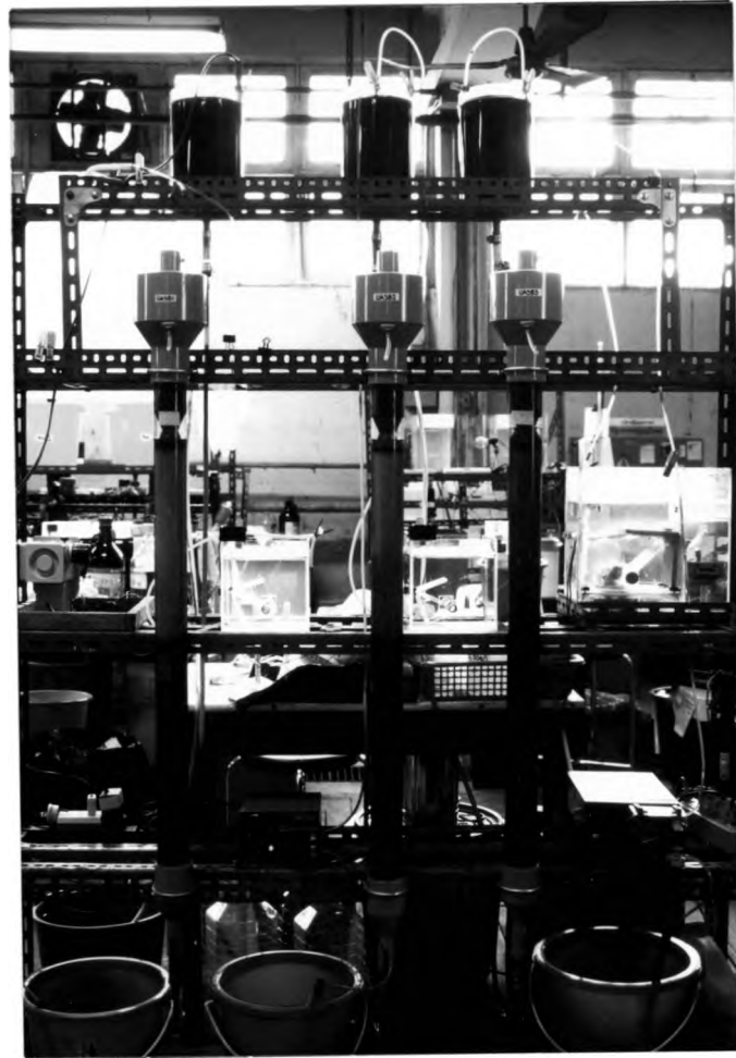
รูปที่ 4.25 การติดตั้งอุปกรณ์ในการทดลองกับน้ำย้อมสีน้ำเงิน
