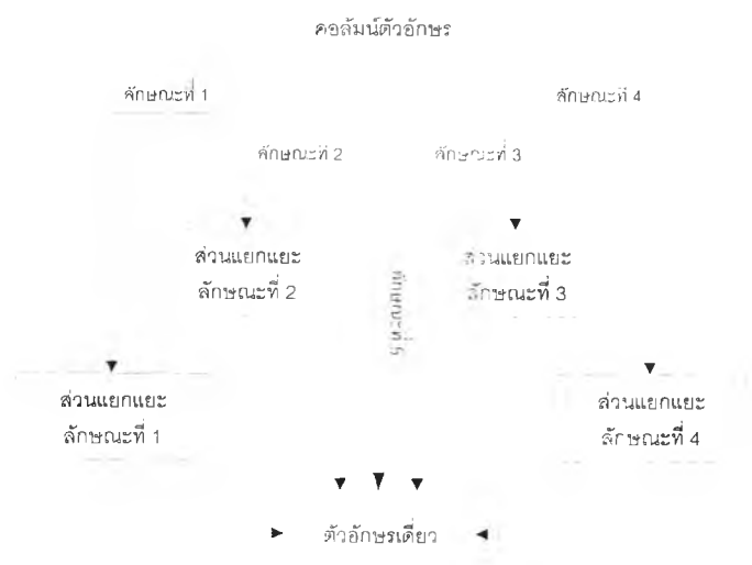
รูปที่ 3-6 แสดงผังหลักการทำงานของส่วนแยกแยะลักษณะตัวอักษร
