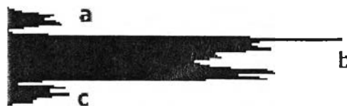
ภาพที่ 3-3 แสดง Horizontal Projection ของภาพบรรทัดตัวอักษร
