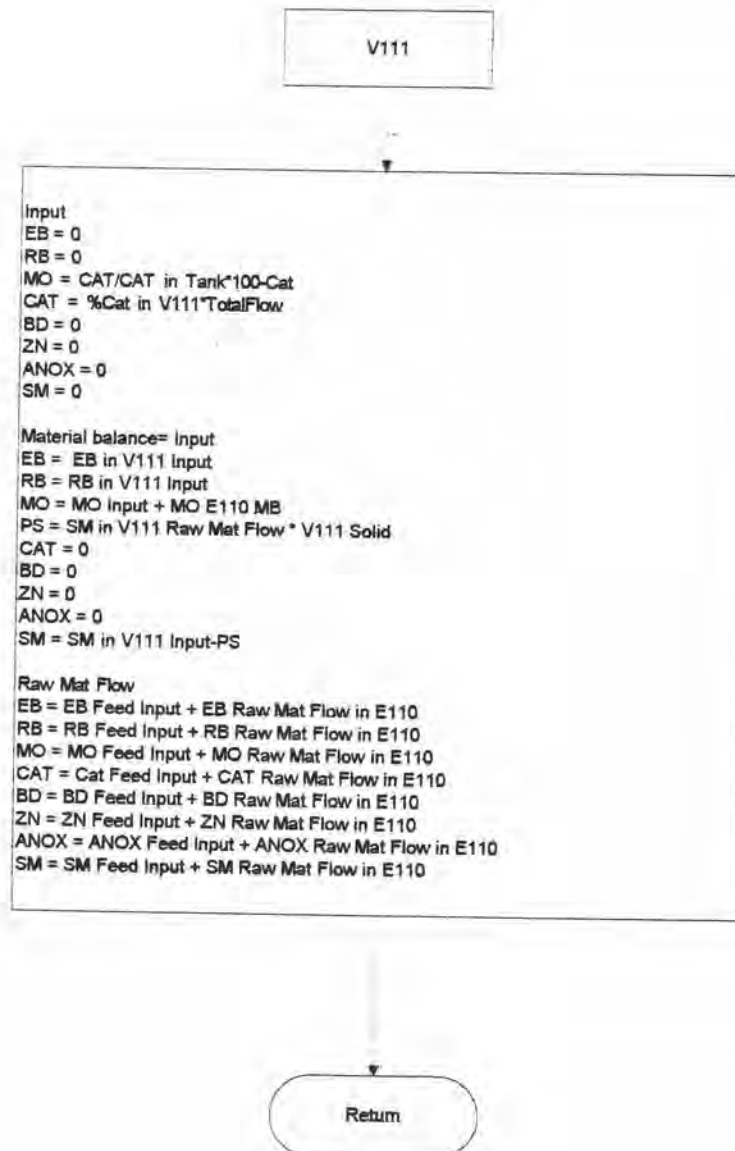
รูป ผ.18 แผนภูมิแสดงการทำงานของโปรแกรมย่อยหน่วยผลิต V111
