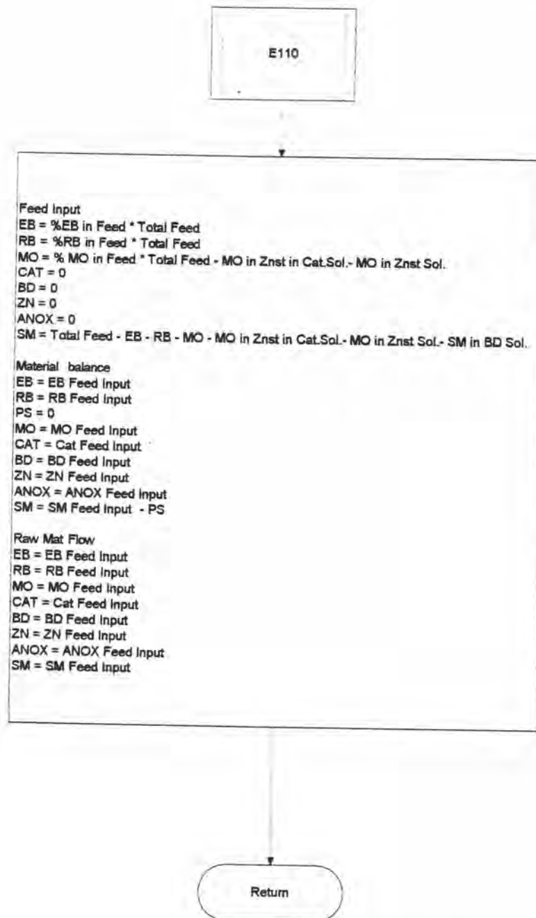
รูป ผ.17 แผนภูมิแสดงการทำงานของโปรแกรมย่อยหน่วยผลิต E110
