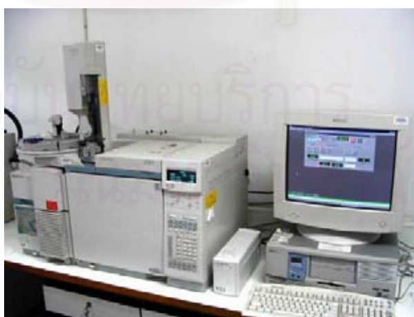
ภาพที่ 3.5 GC ต่อกับ Mass Spectrometer และ auto sampler
