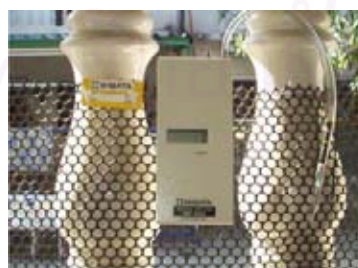
ภาพที่ 3.7 การเก็บตัวอย่างระหว่างวิธีการเก็บแบบ passive และ active
