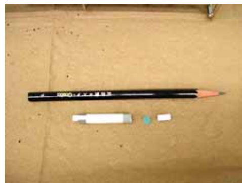
ภาพที่ 3.3 โครงสร้างของ passive sampler (Olansandan และคณะ, 1999)
