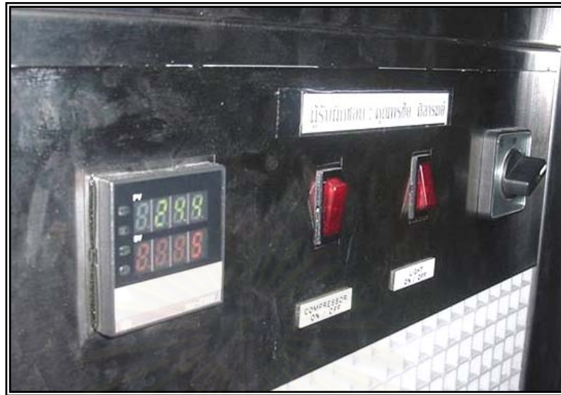
รูปที่ ง-3 แผงควบคุมอุณหภูมิของเครื่อง UTM-5P
