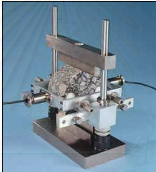
รูปที่ 3.14 การจัดวางก้อนตัวอย่างสำหรับการทดสอบความต้านทานต่อแรงดึงทางอ้อม
