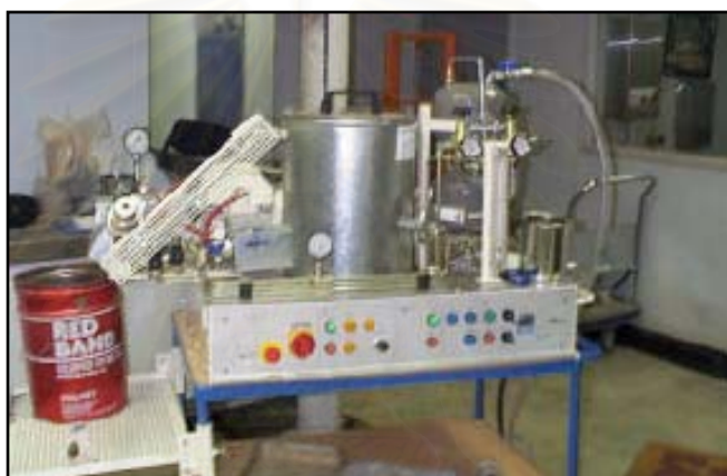
รูปที่ 2.11 ชุดเครื่องมือสำหรับการผลิตโพลีเมอร์แอสฟัลต์
