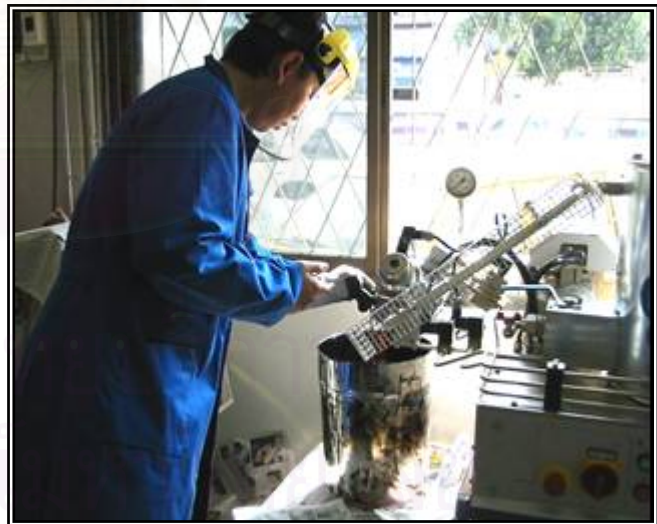
รูปที่ ก-3 การวัดค่าการขยายตัว และค่าครึ่งชีวิต ของโฟมแอสฟัลต์
