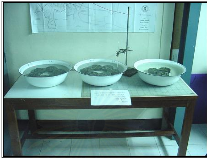
รูปที่ ค-2 การแช่ก้อนตัวอย่างในน้ำที่อุณหภูมิ 25 °C เป็นเวลา 24 ชั่วโมง ก่อนการทดสอบความต้านทานต่อแรงดึงทางอ้อม
