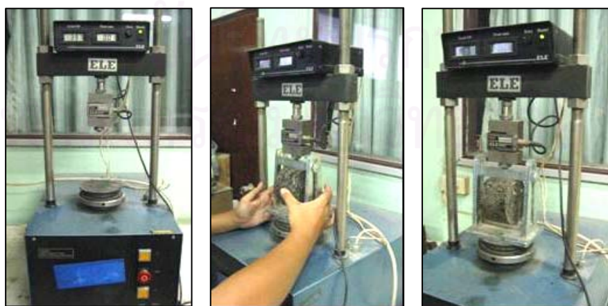
รูปที่ 4.13 เครื่องมือทดสอบและการจัดวางก้อนตัวอย่างในการทดสอบหา ค่าความต้านทานต่อแรงดึงทางอ้อม
