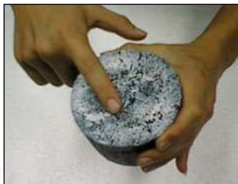
รูปที่ 3.16 การทา Heat Transfer Compound ที่ผิวบนและล่างของก้อนตัวอย่าง
