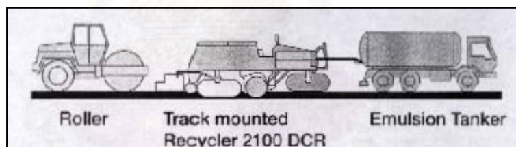
รูปที่ 2.5 ขบวนเครื่องจักรสำหรับงานการใช้แอสฟัลต์อิมัลชัน ที่มา : Wirtgen Cold Recycling Manual (2001)
