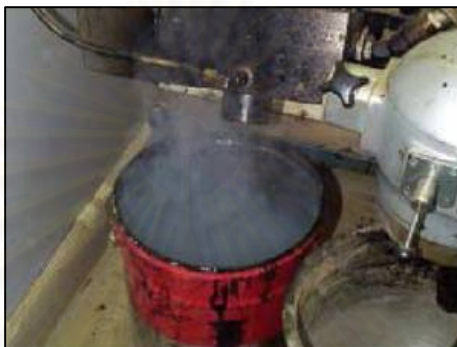
รูปที่ 4.1 โฟมแอสฟัลต์ที่เกิดขึ้นขณะทำการทดสอบ
