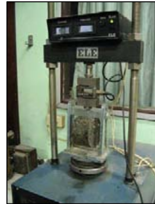
รูปที่ 3.11 การทดสอบค่าความต้านทานต่อแรงดึงทางอ้อมในสภาพที่ผ่านการแช่น้ำ
