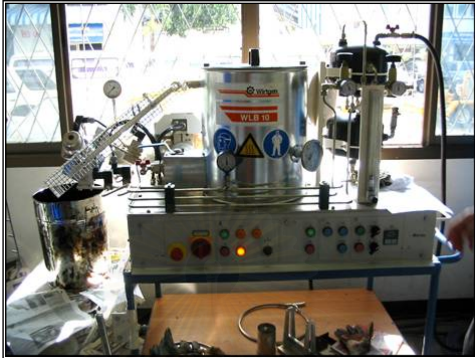
รูปที่ ก-1 เครื่องมือสำหรับผลิตโฟมแอสฟัลต์ในห้องปฏิบัติการ
