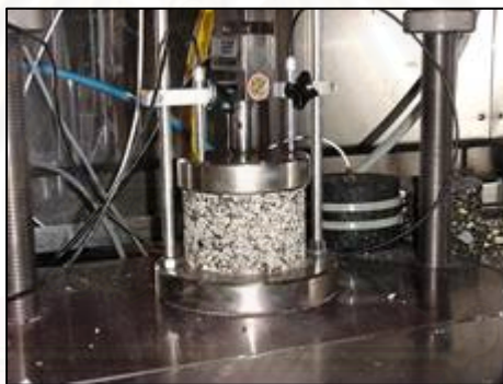
รูปที่ 3.15 การจัดวางก้อนตัวอย่างสำหรับการทดสอบความต้านทานต่อการยุบตัวถาวร
