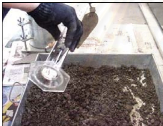
รูปที่ 3.7 ขั้นตอนการผสมน้ำเข้ากับวัสดุมวลรวม
