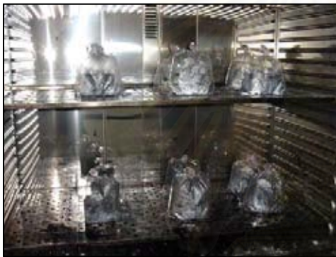
รูปที่ 3.9 การบ่มก้อนตัวอย่างในตู้อบ
