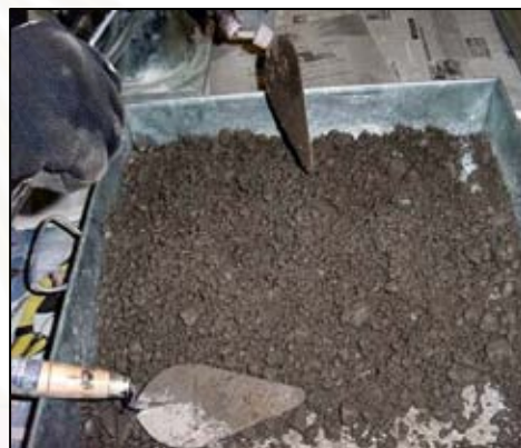
รูปที่ 3.7 ขั้นตอนการผสมน้ำเข้ากับวัสดุมวลรวม
