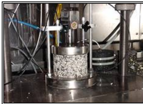
รูปที่ ง-5 การจัดวางก้อนตัวอย่างสำหรับการทดสอบ ความต้านทานต่อการยุบต่อถาวร
