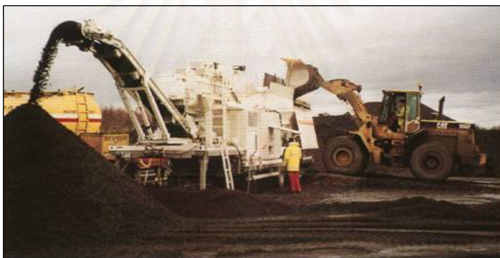
รูปที่ 2.2 เครื่องจักรกลในงานผสมเย็นภายในโรงงาน
