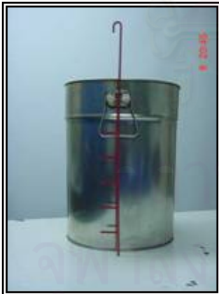
รูปที่ ก-2 อุปกรณ์สำหรับใช้วัด ค่าการขยายตัว และค่าครึ่งชีวิต ของโฟมแอสฟัลต์
