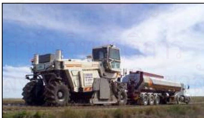
รูปที่ 2.15 เครื่องจักรที่ออกแบบเป็นพิเศษในงานโฟมแอสฟัลต์ ที่มา : Kendall et al (2000)
