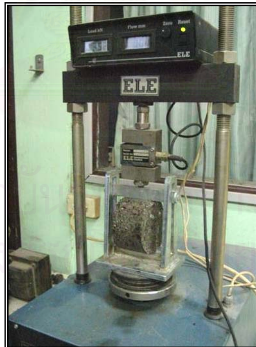
รูปที่ ค-3 การทดสอบความต้านทานต่อแรงดึงทางอ้อม ในขั้นตอนการออกแบบส่วนผสมคอนกรีต
