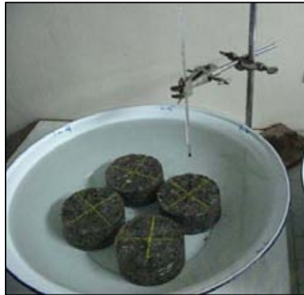
รูปที่ 3.11 การทดสอบค่าความต้านทานต่อแรงดึงทางอ้อมในสภาพที่ผ่านการแช่น้ำ
