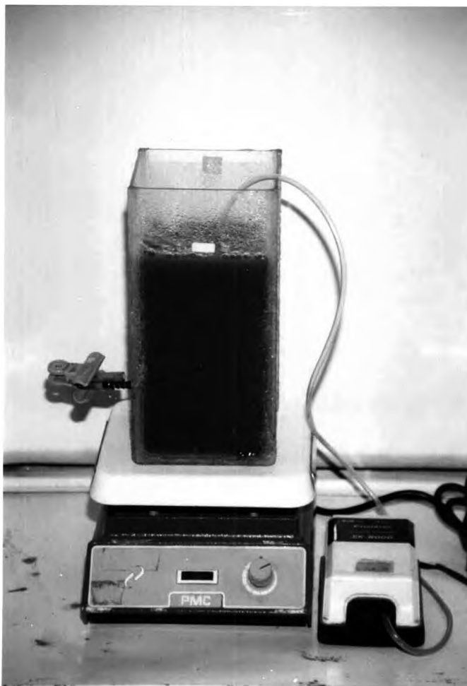
ภาพที่ 3.2 การทดสอบแบบแบตเตอรี่เพื่อหาค่าอัตราการปลดปล่อยและ จับใช้ฟอสฟอรัสจำเพาะ
