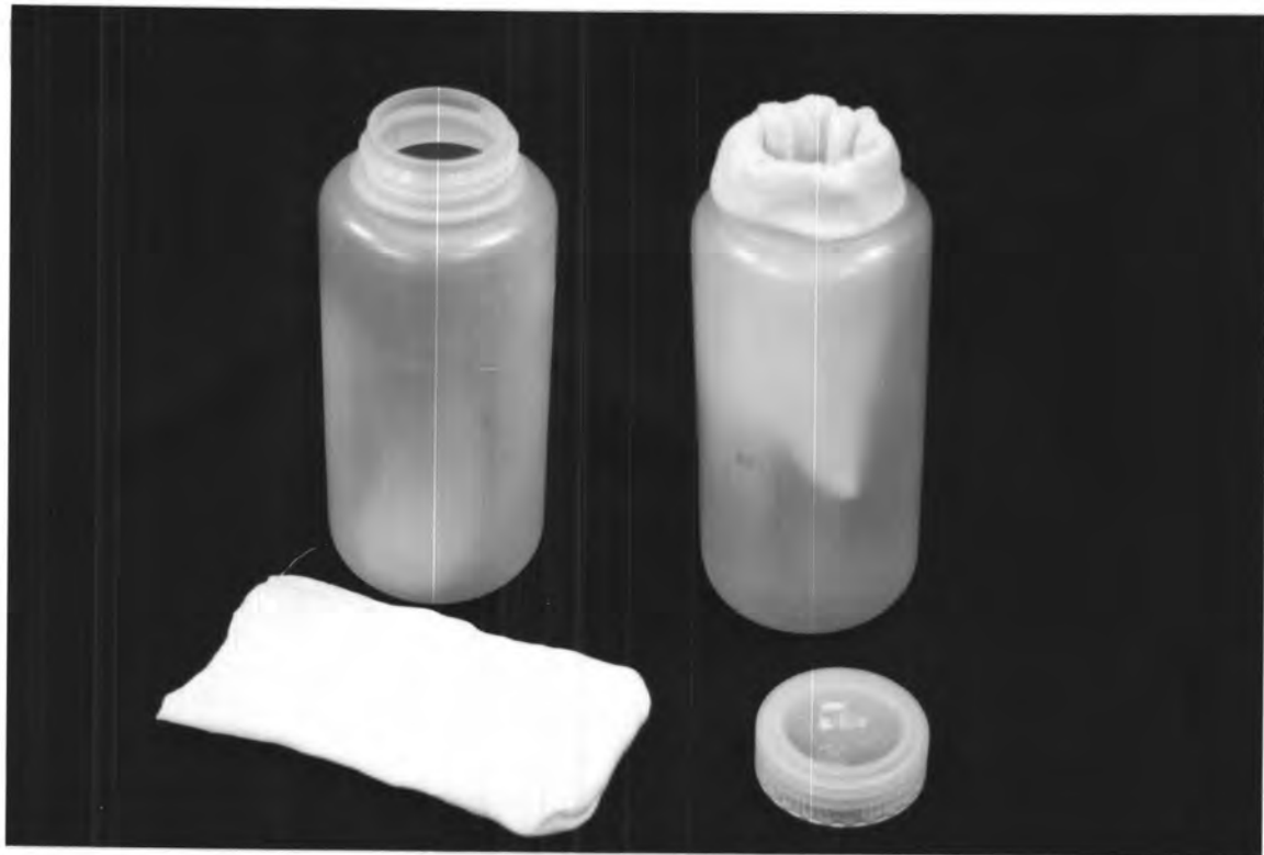
รูปที่ 2-1 ลักษณะของกระบอกปั่น (centrifuge tube) ที่มีการดัดแปลงโดยใส่ถุงกรองไว้ข้างในเพื่อใช้ในการปั่นแยกส่วนกากมันสำปะหลังที่ผ่านการย่อยกับส่วนของสารละลายที่ได้ออกจากกัน
