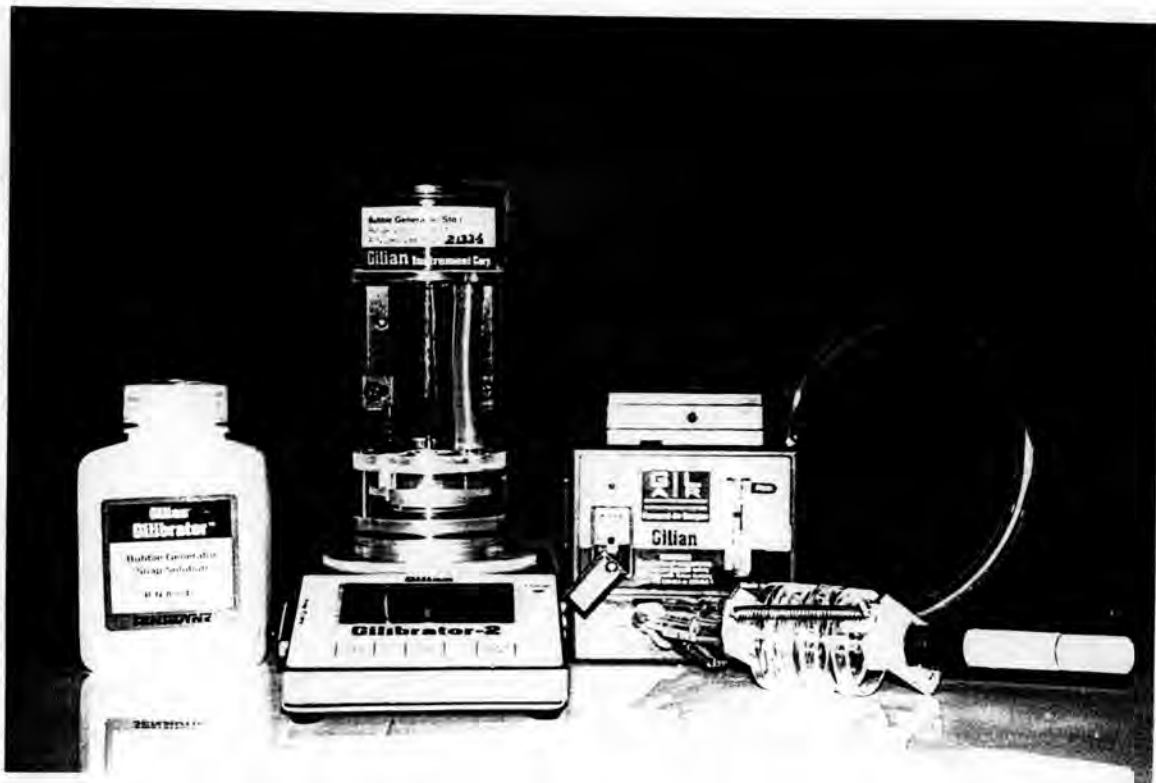
รูปที่ 3.1 ลักษณะทั่วไปของเครื่องเก็บตัวอย่างอากาศแบบติดตัว (Personal sampler) และ cyclone พร้อมชุด calibrate
