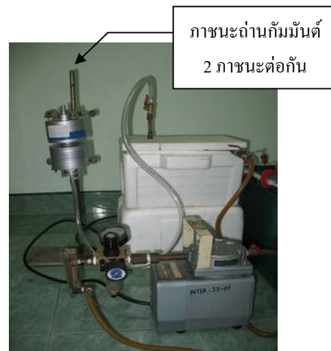
รูปที่ 3.9 รูปถ่ายการต่ออุปกรณ์เพิ่มความเข้มข้นเรดอนกับภาชนะบรรจุถ่านกัมมันต์
