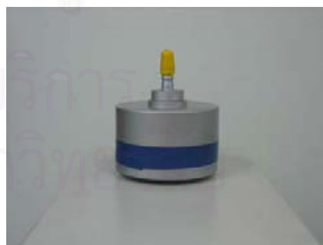
รูปที่ 3.4 ภาชนะพลาสติกบรรจุถ่านกัมมันต์ที่ปิดผนึกแล้ว
