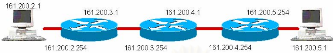
รูปที่ 16 การเชื่อมต่อระหว่าง router กับ client และ หมายเลข ip
