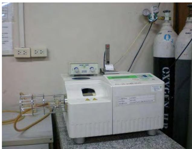
รูปที่ 3.8 เทอร์โมกราวิเมตริกแอนาไลเซอร์ของ METTLER TOLEDO รุ่น TGA/SDTA 851<sup>o</sup>
