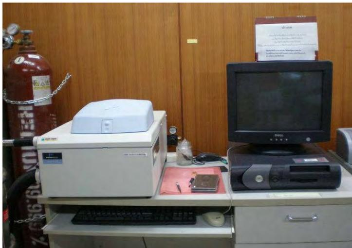
รูปที่ 3.7 ดีฟเฟอเรนเชียลสแกนนิ่งคาลอริมิเตอร์ ของ Perkin Elmer รุ่น Diamond DSC
