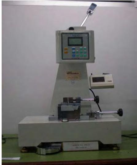
รูปที่ 3.15 เครื่องทดสอบความทนแรงกระแทกรุ่น GT-7045-MDH
