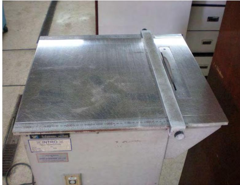
รูปที่ 3.13 เครื่องตัดชิ้นงาน
