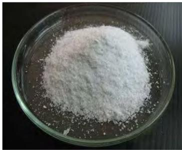
รูปที่ 4.1 ขวดน้ำดื่มเพตีใช้แล้วที่ถูกบดด้วยเครื่องพัลเวอไรเซอร์
