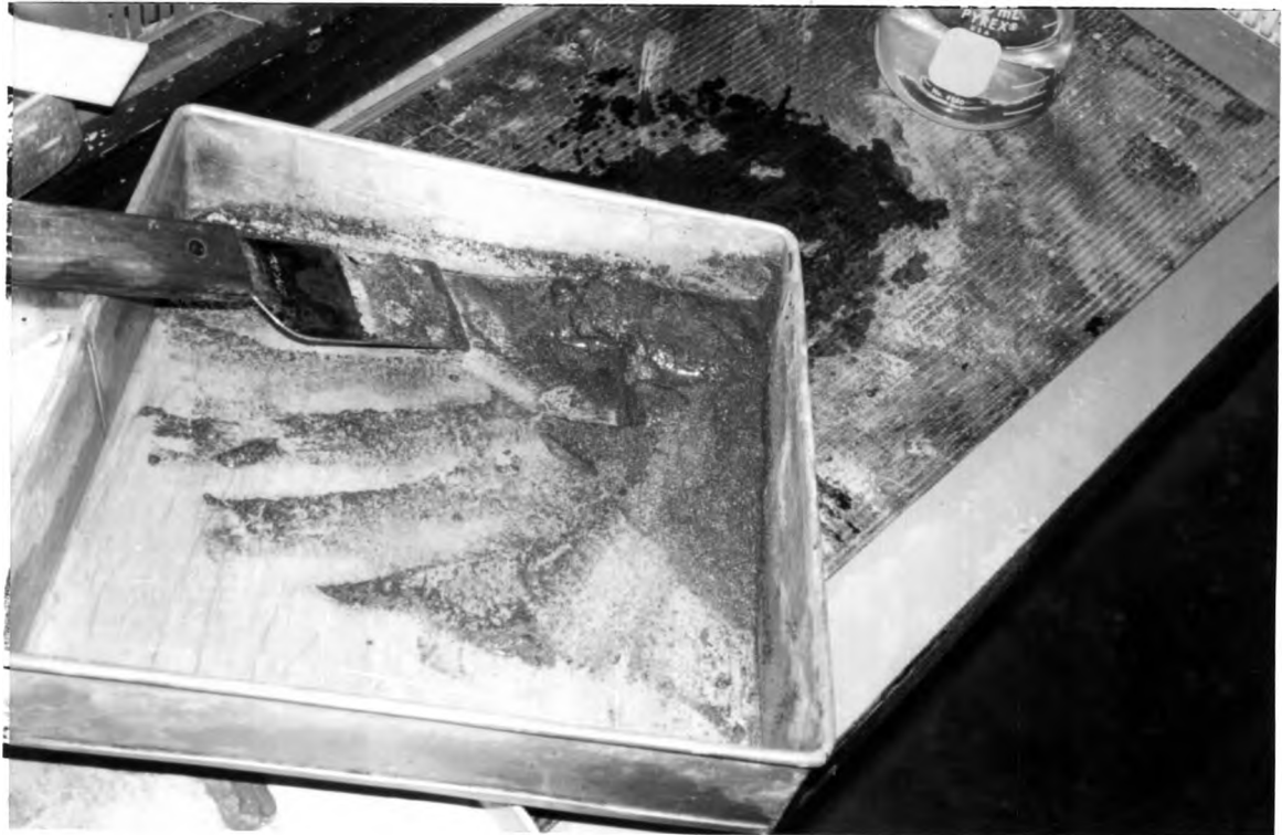
รูปที่ ๑-4 การผสมสารละลายโซเดียมซัลไฟด์ลงใน กากเศษสีถึงบรรจุก๊าซ LPG.
