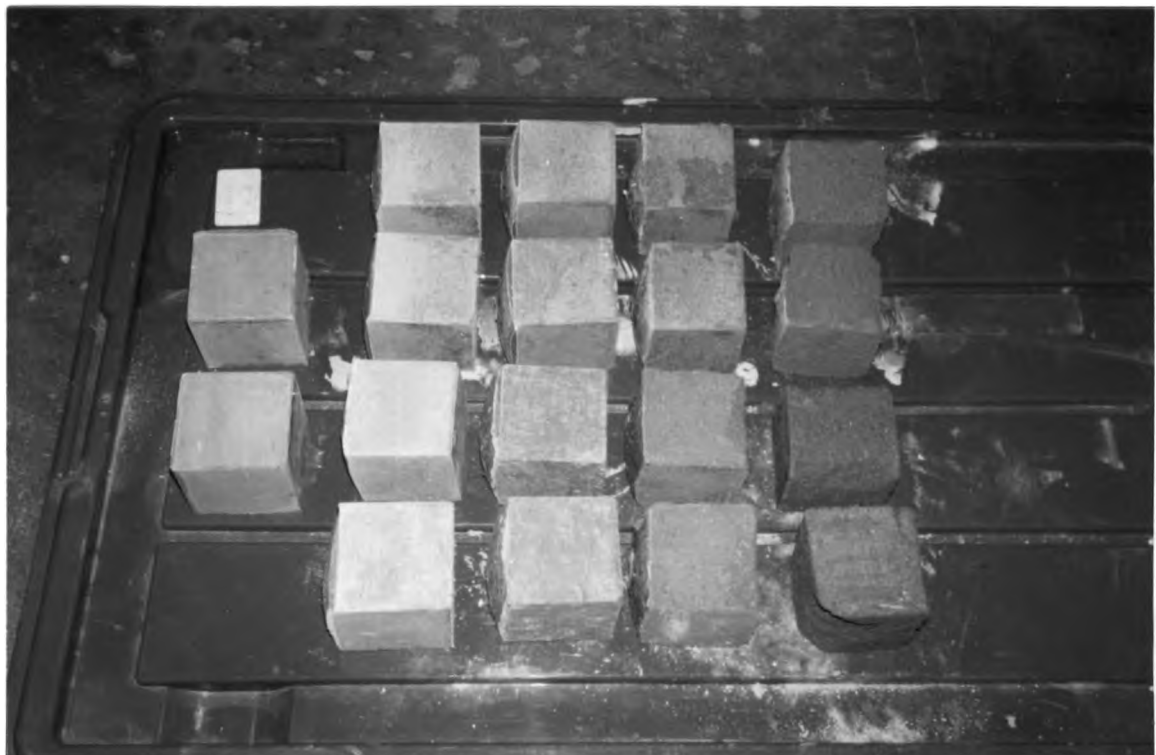
รูปที่ จ-10 ลูกปูนที่ผ่านการบ่มที่ 28 วัน.
