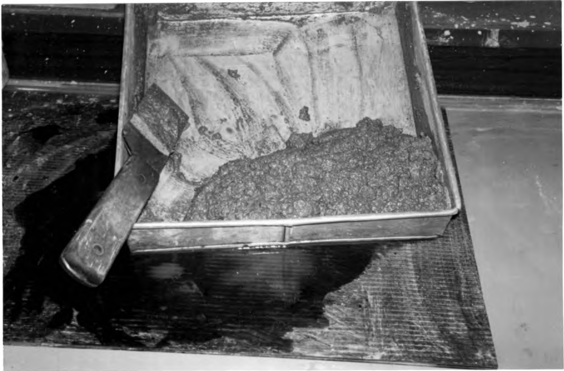
รูปที่ จ-7 วัสดุประสานเมื่อผสมให้เข้ากันจนเป็นเนื้อเดียวกัน.
