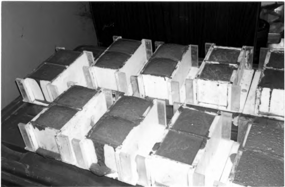
รูปที่ จ-8 การหล่อวัสดุประสานในแบบหล่อในการทำเป็นก้อนแข็ง (Solidification).
