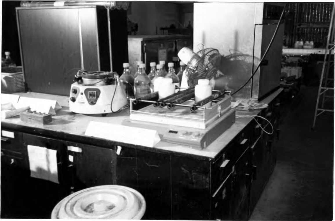
รูปที่ จ-11 เครื่องเขย่า 200รอบ/นาที เพื่อทดสอบการชะละลาย.
