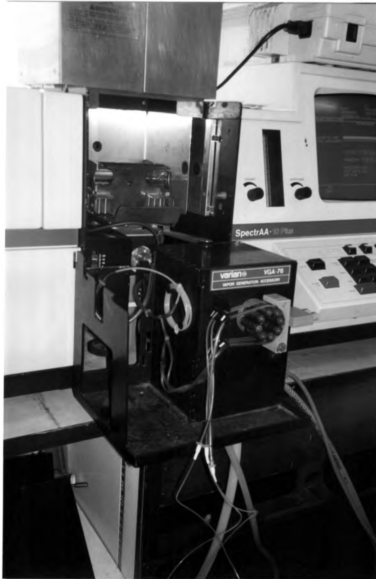
รูปที่ จ-13 เครื่องวัดปริมาณโลหะโดยใช้ เครื่องอะตอมมิกแอบซอร์ปชันสเปกโทรโฟโตมิเตอร์.
