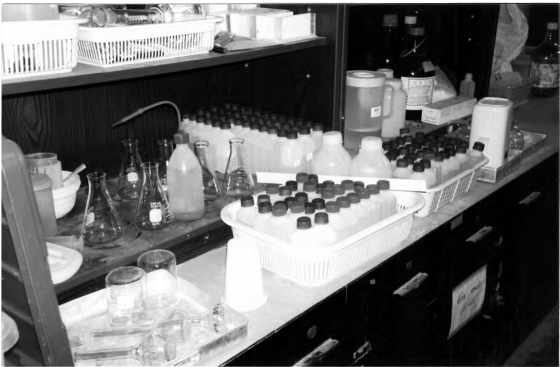
รูปที่ จ-12 น้ำสกัดที่ได้จากการเขย่าจะถูกนำมาวัดปริมาณโลหะต่อไป.
