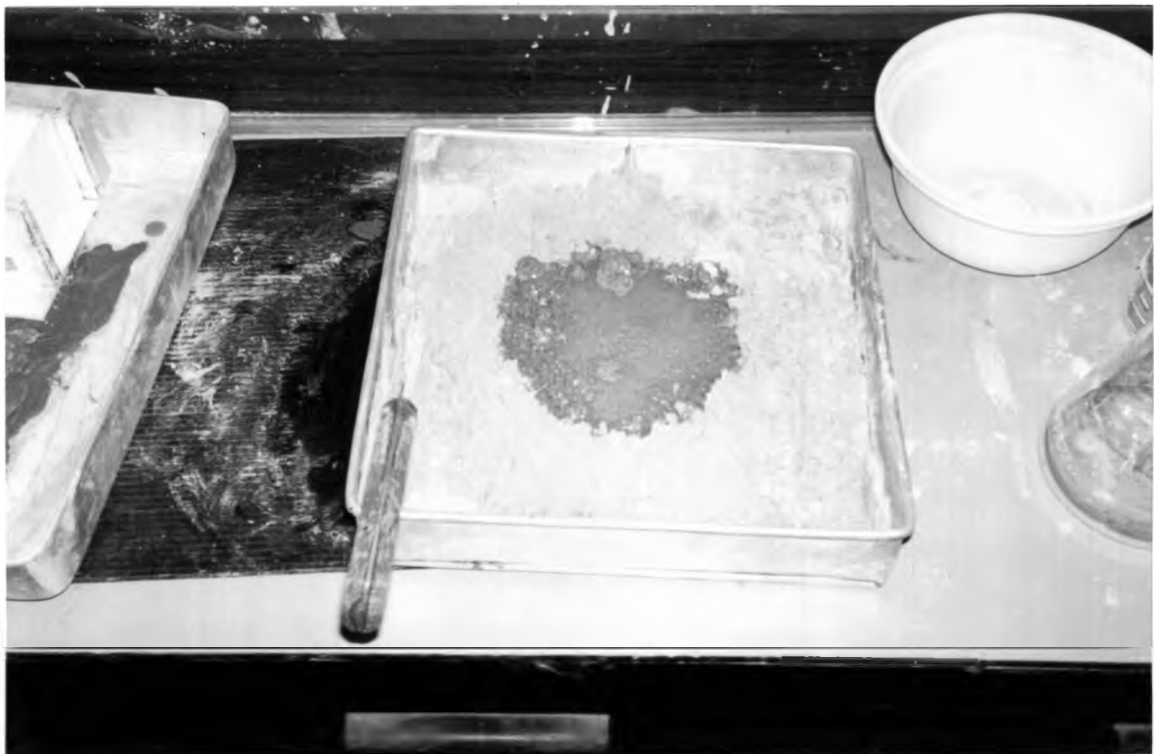
รูปที่ ๑-6 การเติมน้ำลงในวัสดุประสาน.
