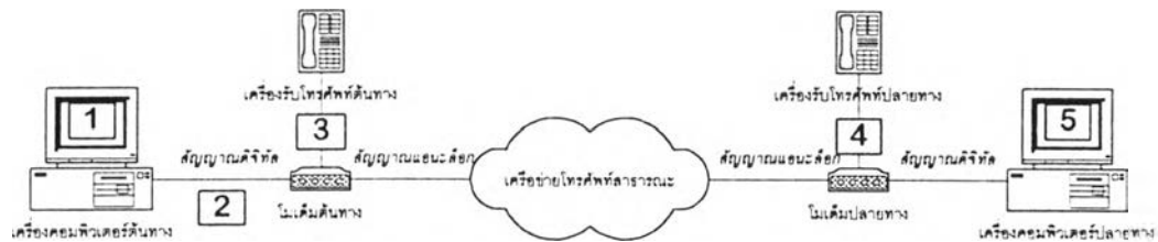
รูปที่ 4.1 แสดงการทดสอบการรับส่งข้อมูลในแต่ละช่วงของอุปกรณ์
