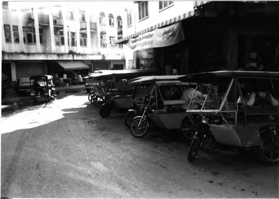
รูปที่ 4.1 รถจักรยานยนต์รับจ้างที่ต่อเติมที่นั่งโดยสารและบรรทุกของ
