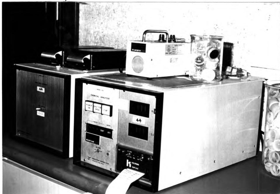
รูป 3.10 เครื่องมือใช้ในการวัดค่าปริมาณกำมะถันในน้ำมัน
