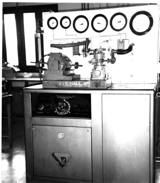
รูปที่ 3.1 แสดงเครื่อง REFRIGERATION CALORIMETER ที่ใช้ในการทดลอง
