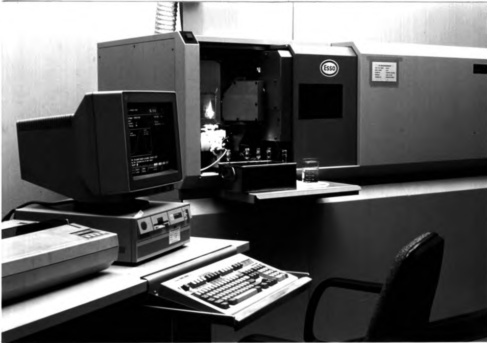
รูป 3.5 เครื่อง ICP ที่ใช้ในการวัดค่าปริมาณโลหะในน้ำมัน
