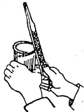
แยกขอบฝาออกจากขอบตัวแล้ววัด
