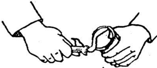
การฉีกออกดูขอบฝา และขอบตัว
