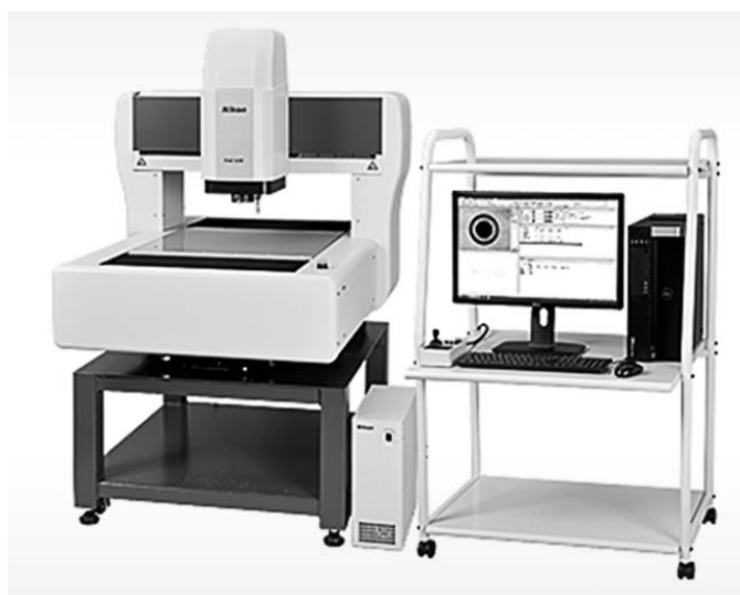
รูปที่ 3-2 เครื่องวัดขนาดอัตโนมัติที่วัตถุอยู่หนึ่ง ๆ แล้วกล้องขยับเพื่อถ่ายรูป [37]
