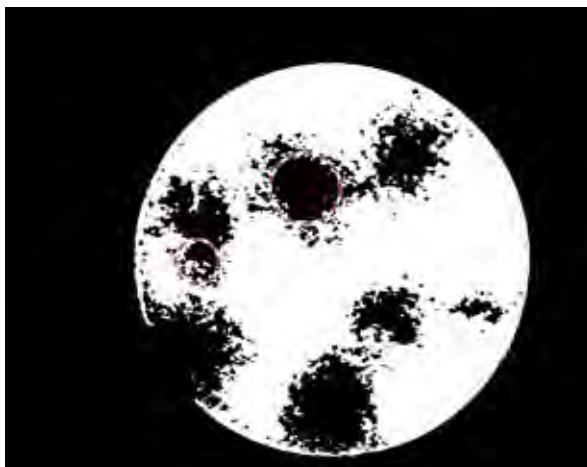
รูปที่ 2-32 ภาพแสดงการใช้ Hough transform เพื่อหาวงกลม
