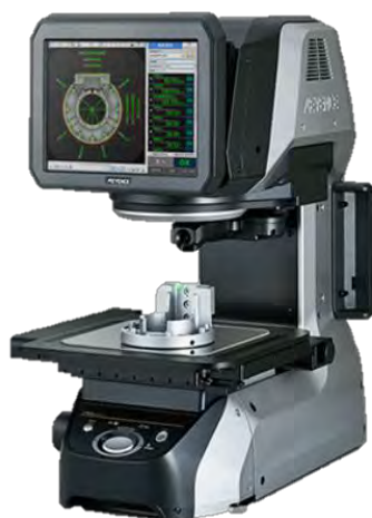
รูปที่ 3-1 เครื่องวัดขนาดอัตโนมัติที่กล้องอยู่หนึ่งๆแล้วขยับวัตถุเพื่อถ่ายรูป [36]
