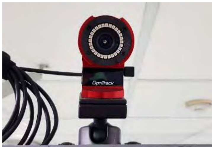
รูปที่ 3.2 กล้องอินฟราเรด รุ่น Flex 13 ความละเอียด 1.3 ล้านพิกเซล
