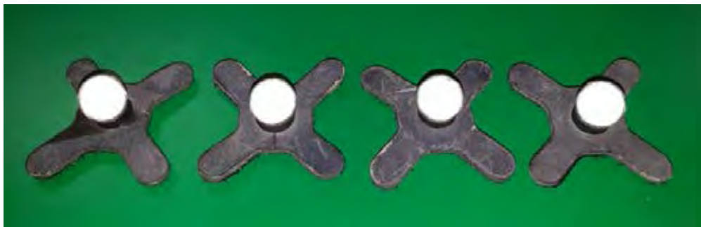
รูปที่ 3.3 มาร์คเกอร์แบบลูกบอล ขนาดเส้นผ่านศูนย์กลาง 14 มิลลิเมตร
