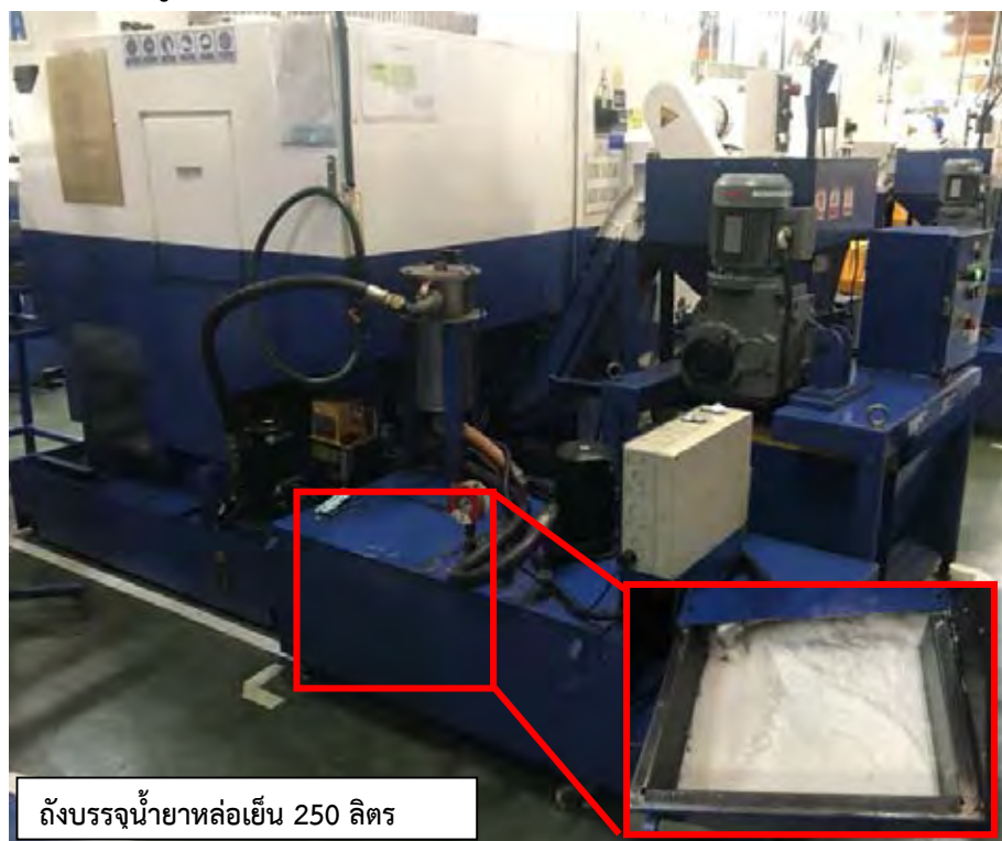
รูปที่ 1.7 เครื่องกลึงโอพีหนึ่งที่ใช้เป็นกรณีศึกษา (ด้านหน้า)
