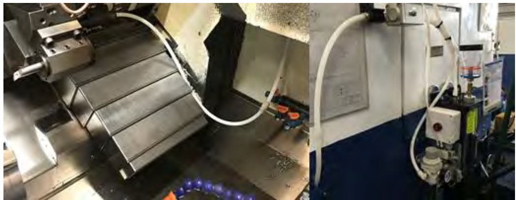
รูปที่ 3.7 การติดตั้งระบบสเปรย์สารหล่อเย็น
