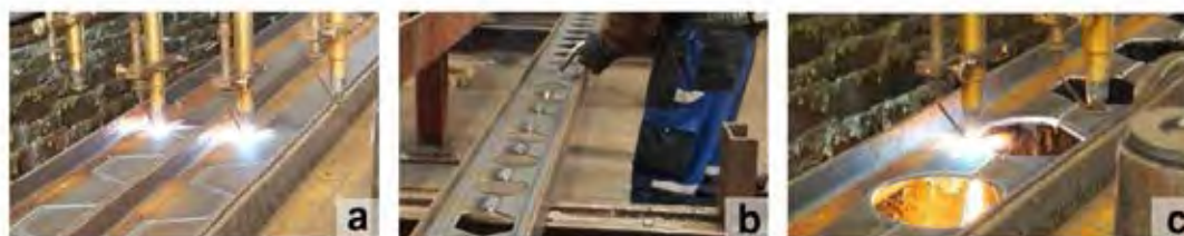
ภาพที่ 2.12 กระบวนการผลิตและประกอบ (a) การตัดแผ่นตั้ง (b) การเชื่อมองค์อาคาร castellated ระหว่างท่อนบนและท่อนล่างเข้าด้วยกัน (c) การตัดเพิ่มของช่องเปิดวงกลมในตัวอย่าง CS2 [5]
