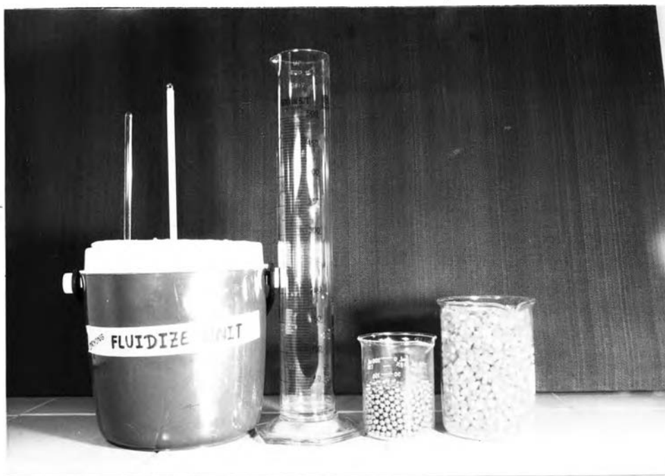
รูปที่ 4.1 เครื่องมือหาความจุความร้อนของข้าวโพด
