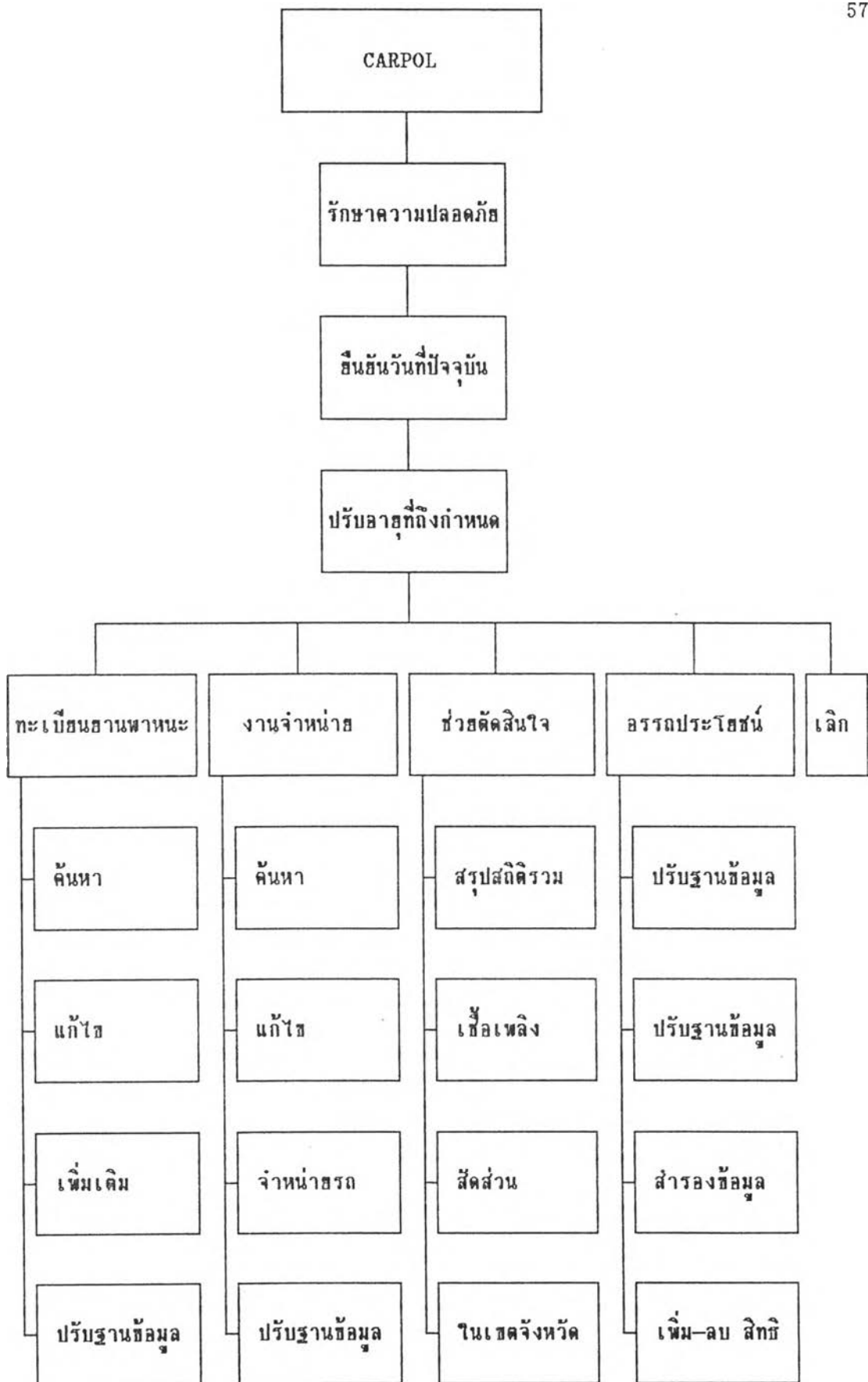
แผนภาพที่ 4.5 แผนภาพต้นไม้แสดงผังการทำงานของโปรแกรมหลัก
