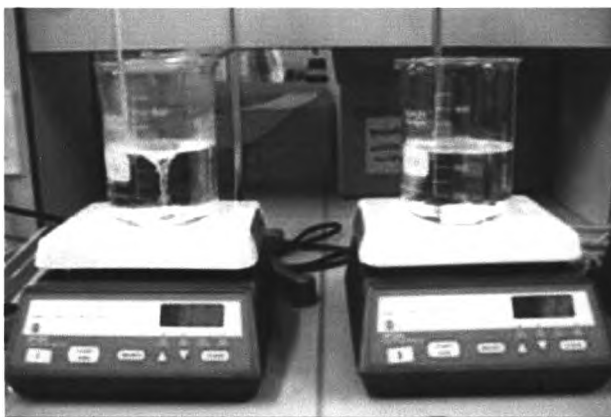
ภาพที่ 3.11 ถังกรด (ซ้าย) และถังล้าง (ขวา) สำหรับการทดลอง
