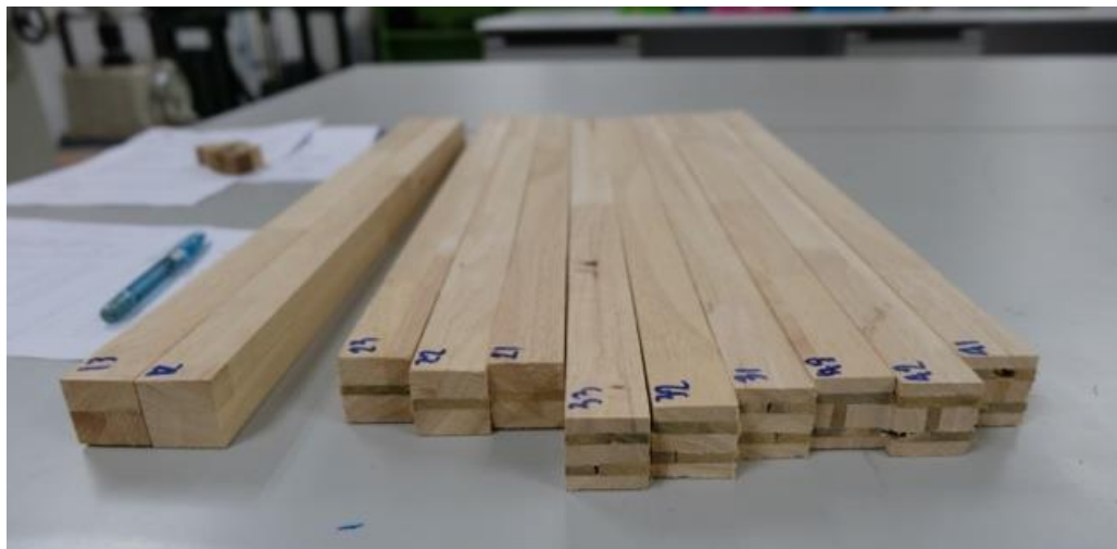
ภาพที่ 39 แสดงต้นแบบวัสดุผสมไม้ไผ่ประกบกับกาวและไม้ยางพาราสำหรับทดสอบคุณสมบัติเชิงกล
