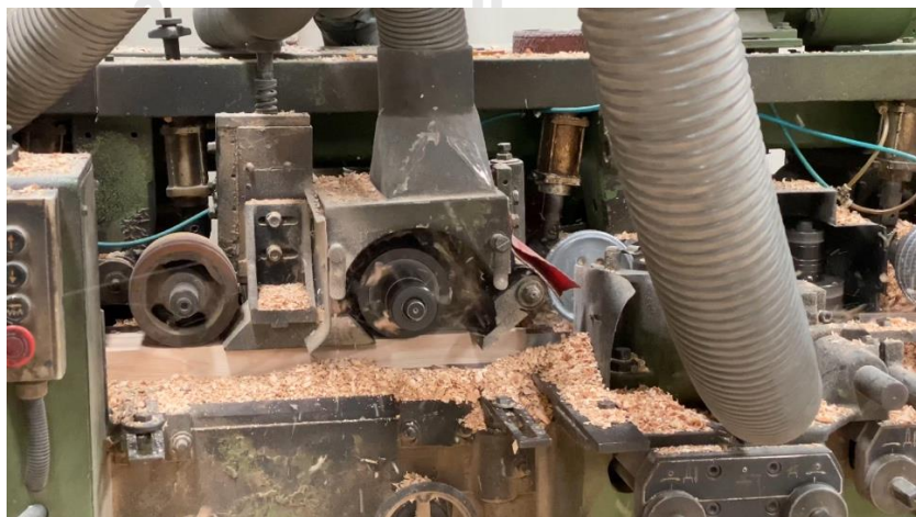
ภาพที่ 53 ขั้นตอนการใสความหนาให้ได้ขนาด 2x4 นิ้ว
