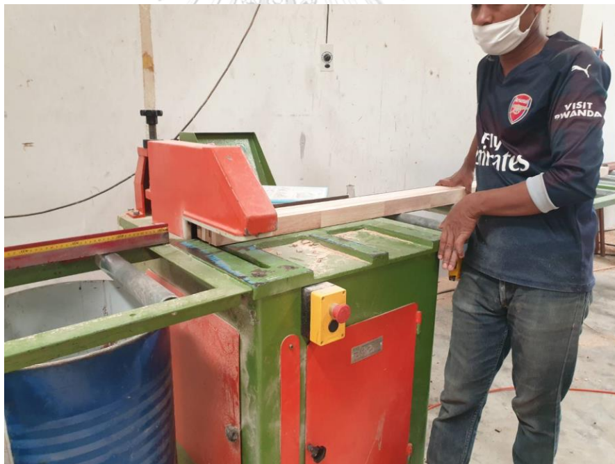
ภาพที่ 55 แสดงขั้นตอนการตัดหัวและท้ายของวัสดุ
