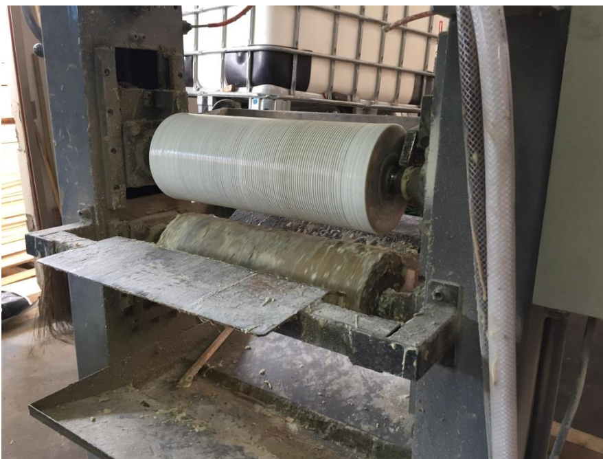
ภาพที่ 4 แสดงเครื่องทากาวเพื่อเตรียมไม้แปรรูปสำหรับนำมาใช้ในกระบวนการอัดประสาน ด้วยระบบไฟฟ้า ของบริษัทอินเตอร์วูด ภาพถ่ายเมื่อปี พ.ศ.2561
