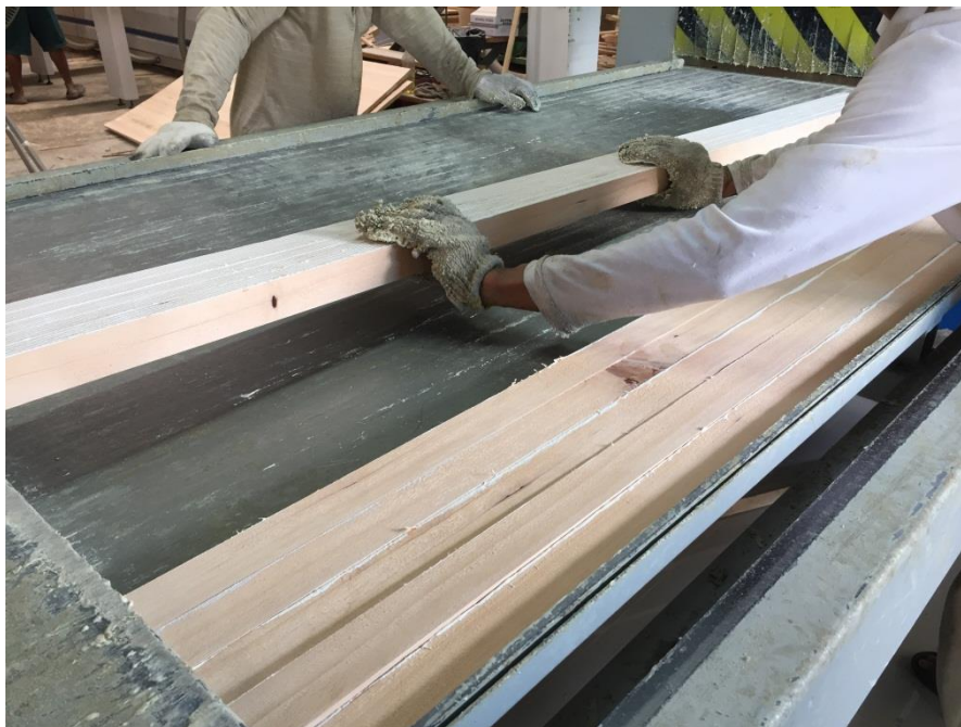
ภาพที่ 3 แสดงการเตรียมไม้สนอเมริกาเพื่ออัดประสานด้วยระบบไฟฟ้าภายในโรงงาน ของบริษัทอินเทอร์เน็ต ภาพถ่ายเมื่อปี พ.ศ.2561
