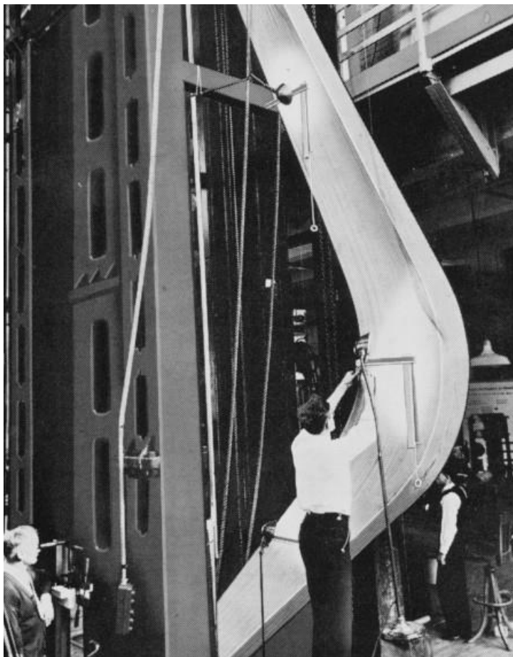
ภาพที่ 2 การทดสอบไม้ประกบกาวในห้องทดลองในรัฐวิสคอนซิน ปี ค.ศ.1934
