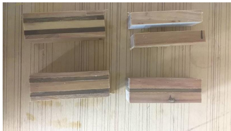
ภาพที่ 97 แสดงการทดสอบคุณสมบัติของกาวในการประกบไม้
