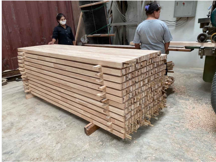
ภาพที่ 54 วัสดุผสมไม้ไฟประกบกับกาวยางพาราประกบกับกาวสำหรับเตรียมตัดขนาดความยาว
