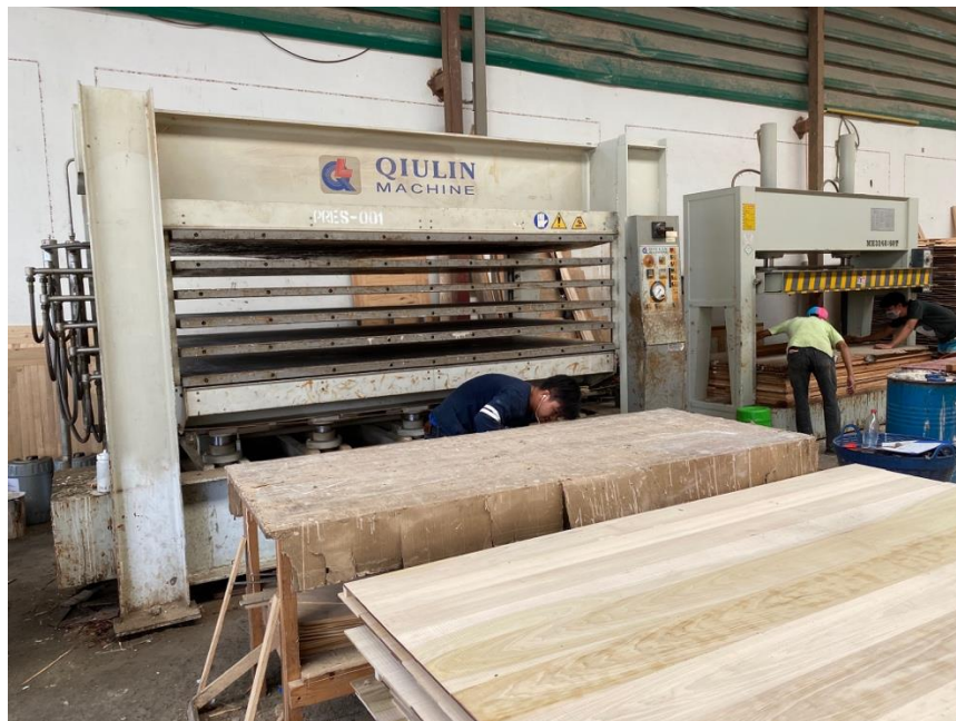
ภาพที่ 50 แสดงเครื่องอัดประกบไม้ประกบกาวแบบอัดเย็น (Cold press)
