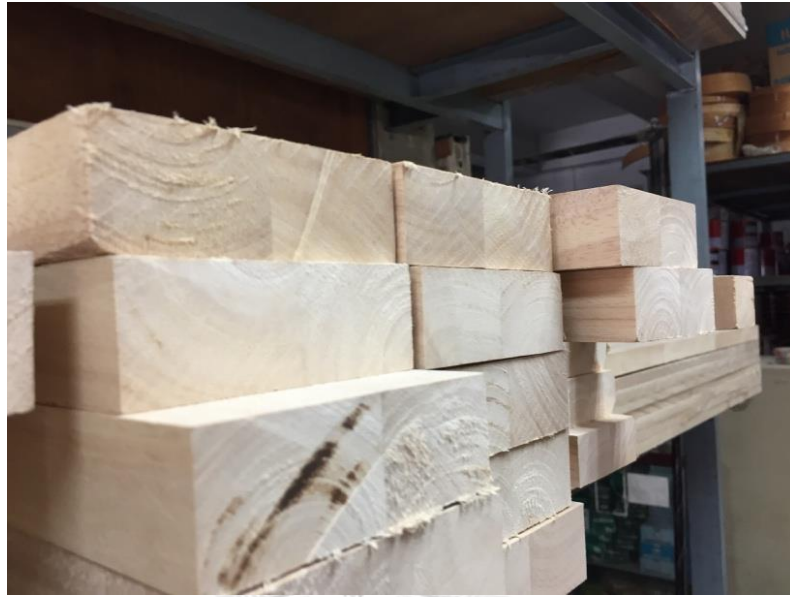
ภาพที่ 13 แสดงไม้ยางพาราประกบกับกาว สายพันธุ์ PB235
