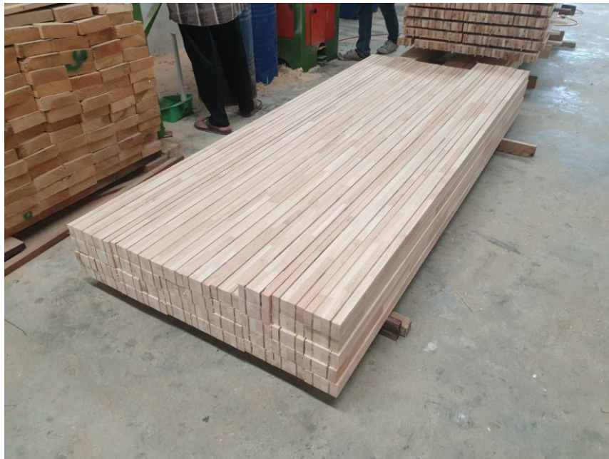
ภาพที่ 56 วัสดุผสมไม้ไผ่ประกบกับกาวยางพารา ขนาด 2x4 นิ้ว
