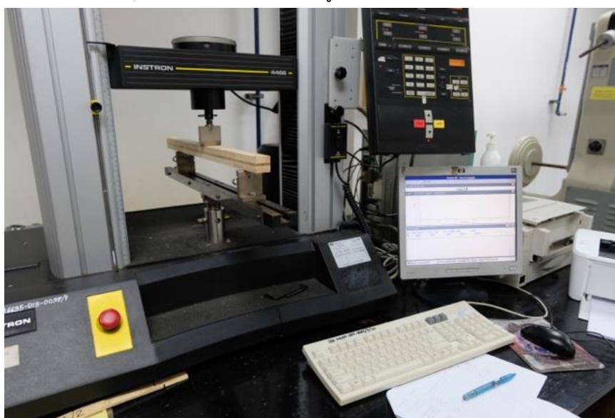
ภาพที่ 40 แสดงการเตรียมเครื่องทดสอบไม้ไผ่และไม้ยางพาราประกบกับกาวภายในห้องทดสอบ
