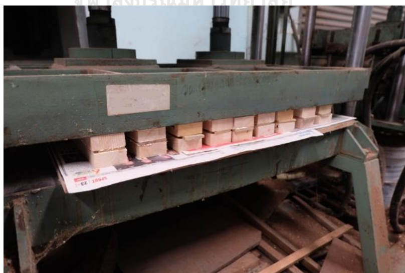
ภาพที่ 38 แสดงประกบไม้โดยวิธีอัดเย็น (Cold Press)
