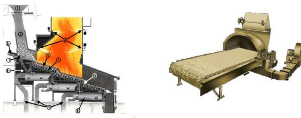
ภาพที่ 14 ลักษณะเตาเผาเชื้อเพลิงระบบสโตเกอร์แบบกระจาย
